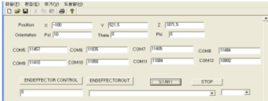
그림 3-4-52. 하이브리드 매니플레이터 역기구학으로 계산된 병렬 매니플레이터의 링크 길이, 베이스 회전 조인트와 직렬 매니플레이터의 회전 각도
