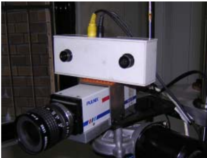
그림 3-3-8. 영상획득용 CCD 카메라
