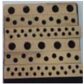
그림 8. 숯보드유공합판복합재료의 표면재 유공합판. 유공면적 25%(대형5구공,중형10구공,소형20구공)
