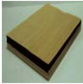
그림 7. 단판오버레이복합재료 숯보드조합 예 표면재:느릅나무0.22mm, 코아재:숯보드 이면재: 합판 15mm 두께
