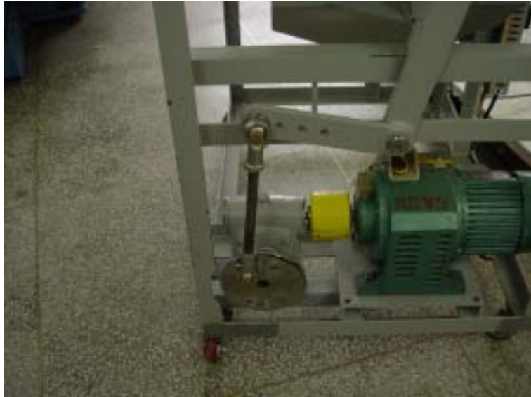
그림 4-14 극선운동 장치와 감속기 연결부
