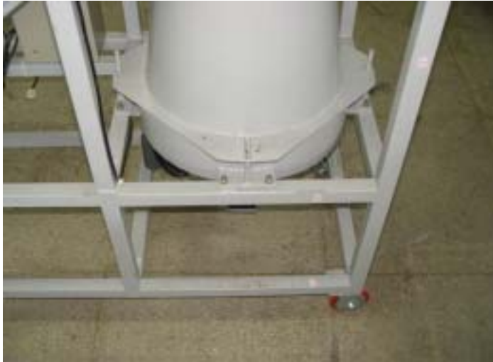
그림 5-10 원추 하부의 프레임과 이송 가이드
