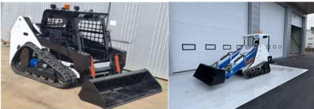
그림 87. 1차 ROPS규정에 의한 캐빈 및 2차 경량화 루프캐노피형 구조 변경
