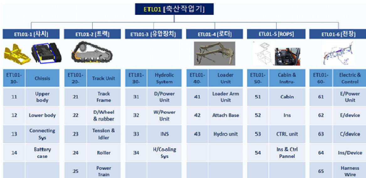
그림 25. 축산작업기 시스템 구성도
