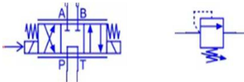
그림 117. 시뮬레이션 모델에서의 솔레노이드 밸브 및 압력조절밸브
