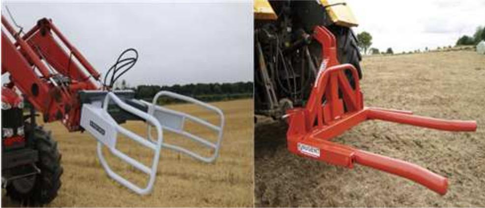
그림 100. 트랙터 부착형 베일 작업기 베일 그립(좌) 및 베일 리프트(우)
