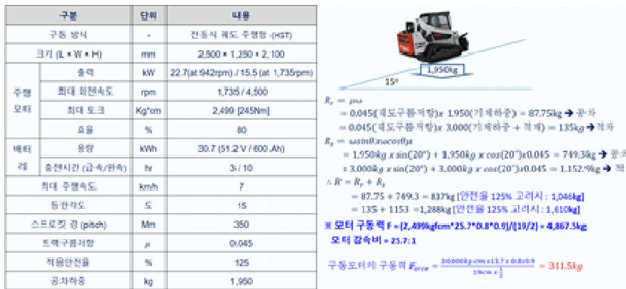
그림 16. 소요성능 분석 및 설계하중에 의한 구동모터 소요동력 검토
