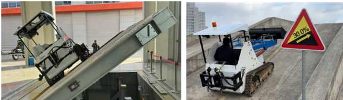
그림 89. 횡전도각 검사 및 등판성능시험
