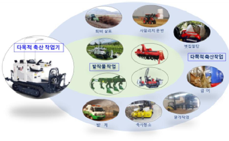
그림 14 로더 및 PTO를 포함하는 3점 히치장치를 구비한 다목적 축산작업기
