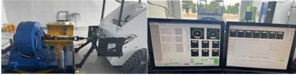
그림 121. PTO 성능시험을 위한 다이나모(좌), 성능 모니터링(우)
