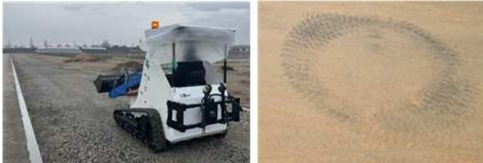
그림 92. 연속주행시험[2024년 01월] 및 회전반경 측정 시험
