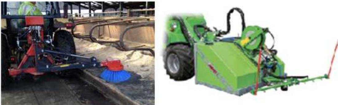
그림 101. 트랙터 부착형 축사용 청소 작업기 브러쉬(좌) 및 고압 살수 살균기(우)
