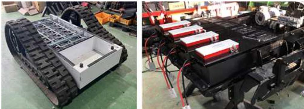
그림 86. 1차 시제품[납산배터리] 및 2차 개선 시제품[리튬이온 배터리]
