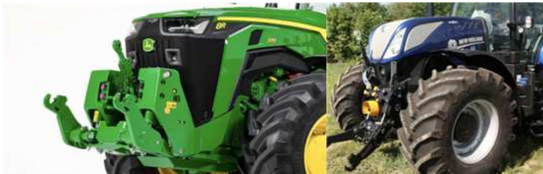
그림 102. 해외 선진사에 적용되는 전방 3점 히치 John deere 사(좌) 및 New holland 사(우)
