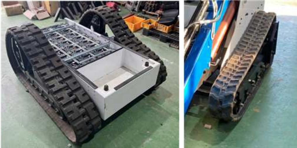
그림 88. 1차 건설장비용 궤도장치 및 2차 농기계용 궤도장치
