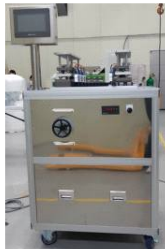
[포장내 플라즈마 장치 초기 Concept 및 최종 제작품]
