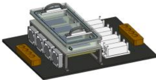
플라즈마 반응기 (좌: 기존 SDBD, 우: Cylindrical type DBD)
