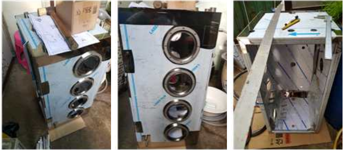
[플라즈마 나노 버블 장치 가공 및 용접]
