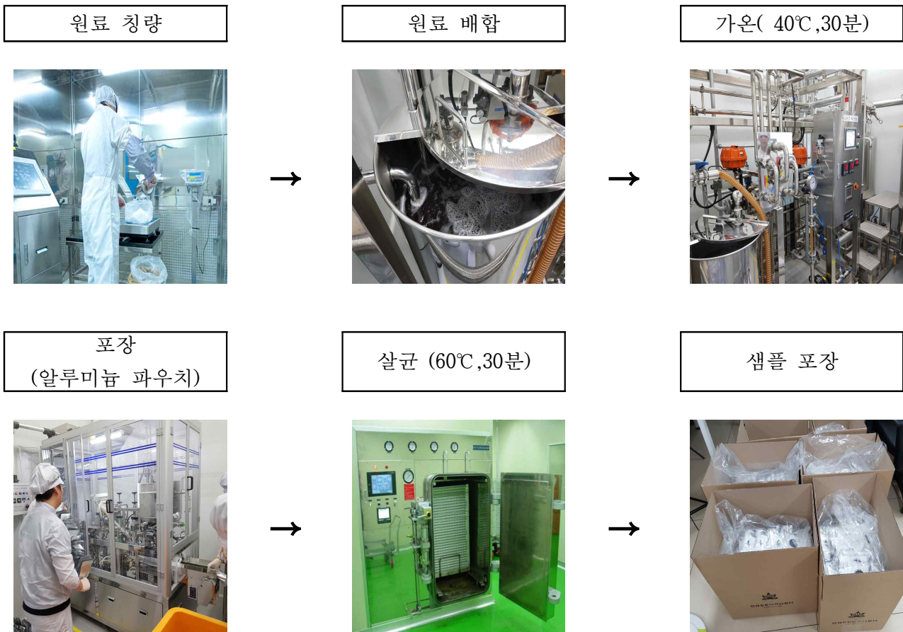
그림 7. 릴렉스 음료 제조 공정
