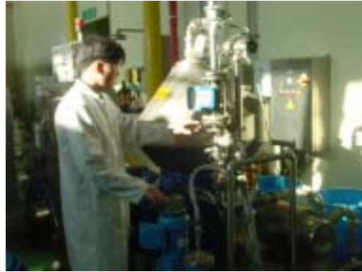
Fig. 192. Pilot 규모의 Alpha laval Disc bowl 타입의 연속원심분리기
