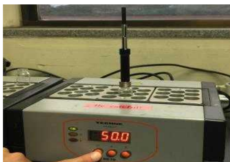
그림 14. HS-SPME(Headspace Solid Phase Micro Extraciton) 방법을 이용한 추출과정
