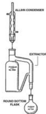
그림 35. 연속적 액체-액체 추출법 (LLE; Liquid-Liquid Continuous Extraction)
