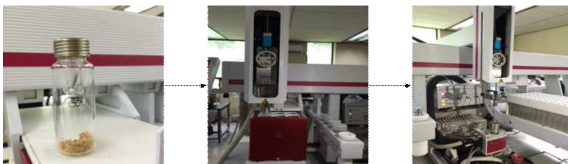
그림 13. HS-SBSE(Headspace Stir-Bar Sorptive Extraction) 방법을 이용한 추출과정
