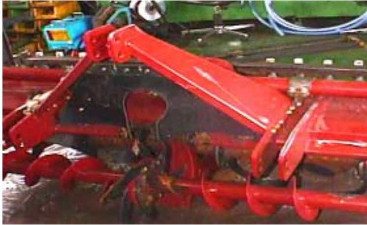
그림 3-1. 고랑타기 및 균평부의 구조
