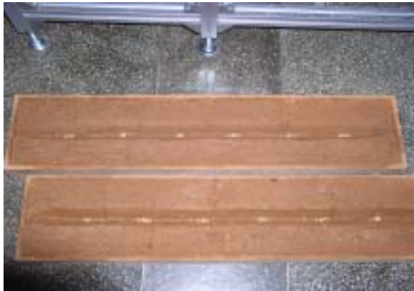
그림 3-25. 실험용 토양상자와 파종된 종자의 모습
