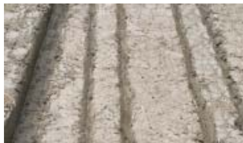
그림 3-39. 고랑과 작조골의 형성상태(함수율 38.8%, 무경운, 0.5m/s)
