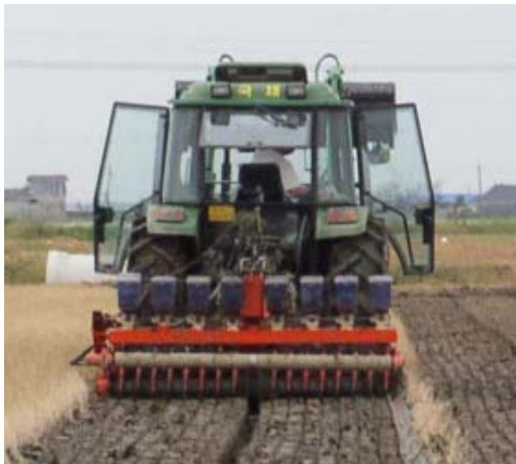
그림 3-38. 고랑타기 및 작조성능 시험 모습
