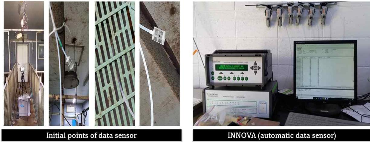
[그림 141] INNOVA를 이용한 가스 분석
