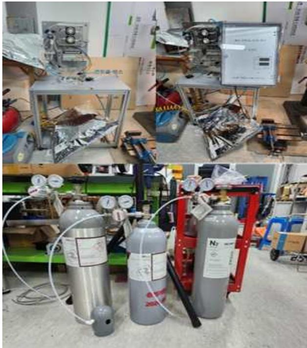
[그림 43] 표준가스를 이용한 정확성 테스트
