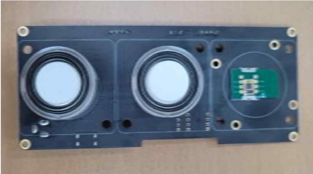
[그림 78] 황화수소(좌), 암모니아(중), 인돌센서(우)를 장착한 센서보드
