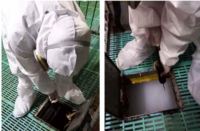
[그림 33] Test-bed 양돈장 슬러리 피트 각 cell에서 발생되는 NH<sub>3</sub> 초기 농도와 거품 도포 후 NH<sub>3</sub> 농도 측정 모습
