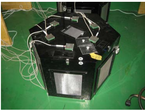
<LED파장대별 유인효과 동시비교 장치 개발> < LED 파장별 해충 반응실험 장치 개발>
