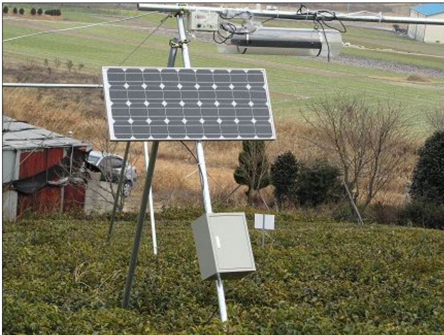
<Solar-Cell을 이용한 해충방제조명>
