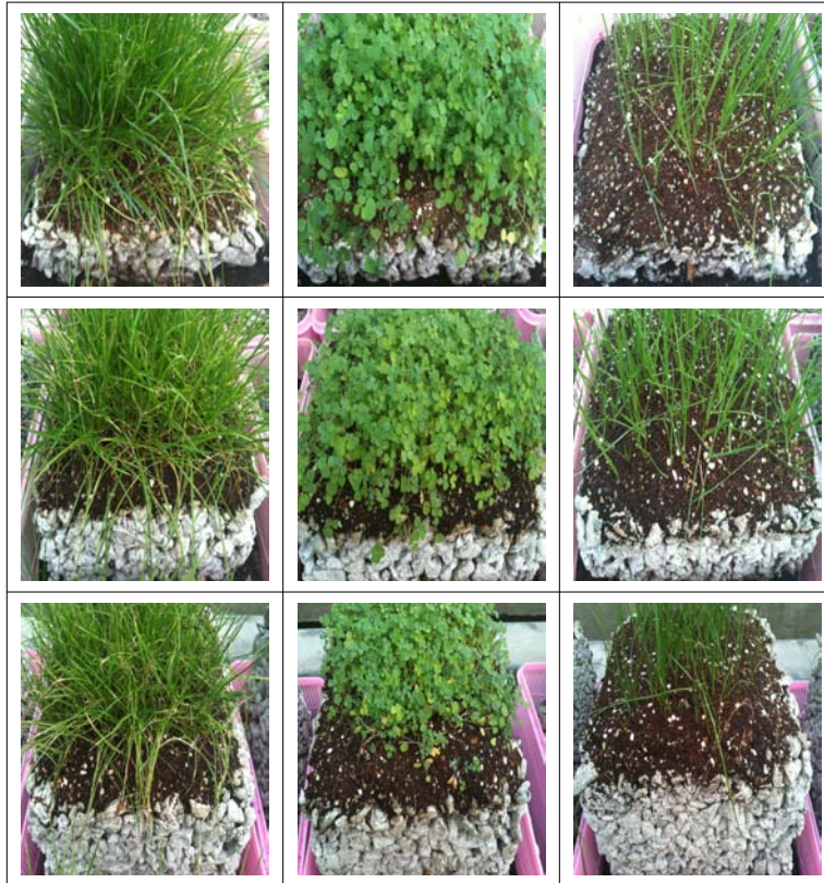
그림 3.4.14 쇠석을 사용한 식생 폴리머 블록에서의 식물의 성장 모습 (파종 후 8주)
