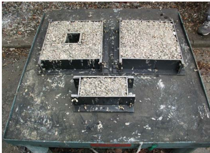
그림 3.3.4 성형을 위한 시료 투입 및 진동 다짐 모습
