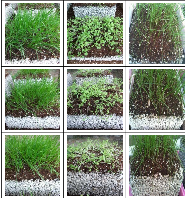
그림 3.4.11 재생골재를 사용한 식생 폴리머 블록에서의 피복 모습 (파종 후 4주)
