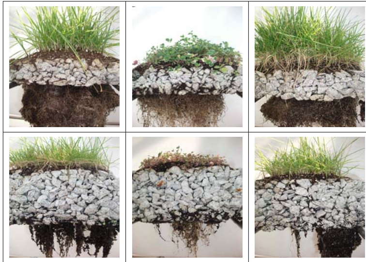
그림 3.4.20 쇠석을 사용한 5cm 및 10cm 식생 폴리머 블록을 통과한 식물의 뿌리 모습 (파종 후 20주)
