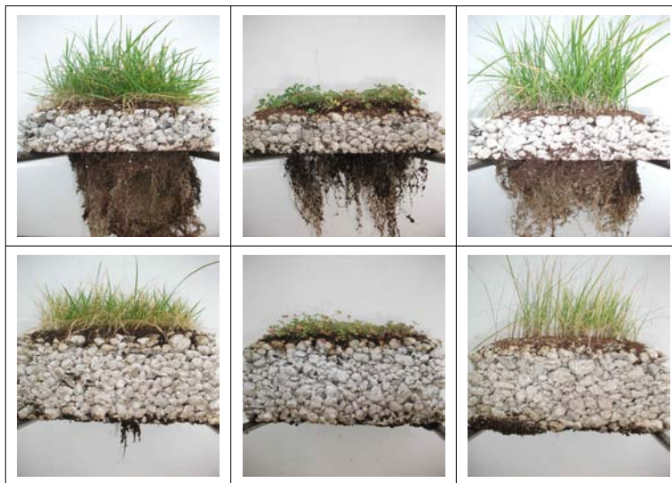
그림 3.4.21 재생골재를 사용한 5cm 및 10cm 식생 폴리머 블록을 통과한 식물의 뿌리 모습 (파종 후 20주)
