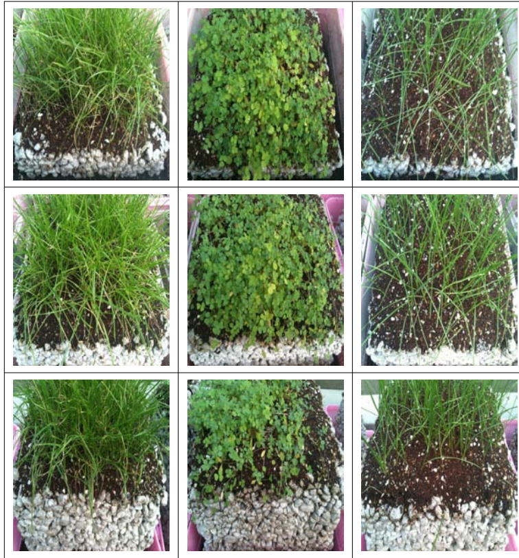
그림 3.4.15 재생골재를 사용한 식생 폴리머 블록에서의 식물의 성장 모습 (파종 후 8주)
