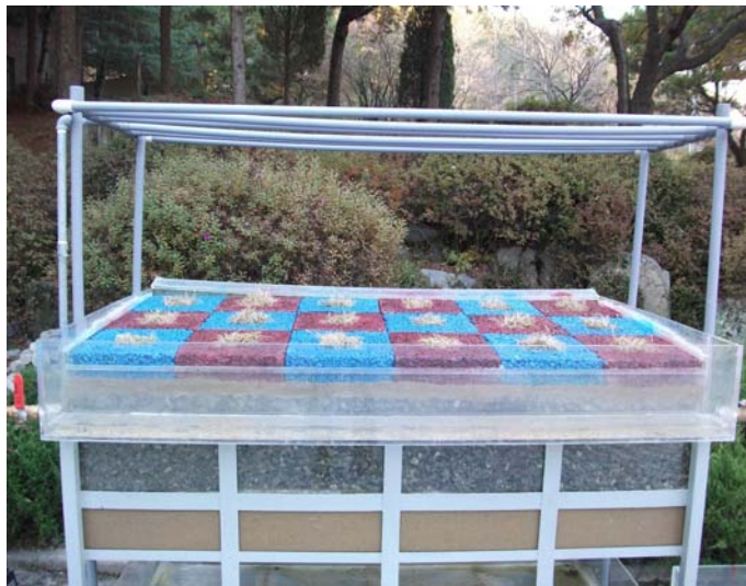
(c) 중공 우수침투형 Green Block과 식생이 조합된 블록 포장 (P-GB-PE + 식생)
