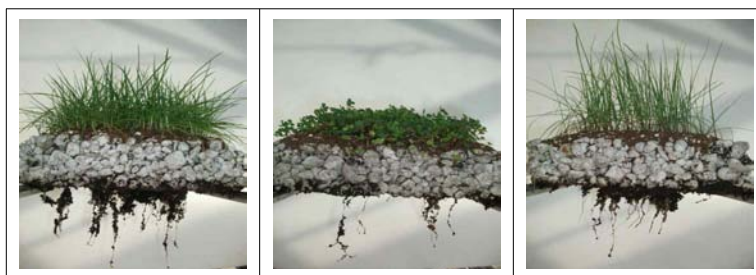
그림 3.4.19 재생골재를 사용한 5cm 식생 폴리머 블록을 통과한 식물의 뿌리 모습 (파종 후 8주)
