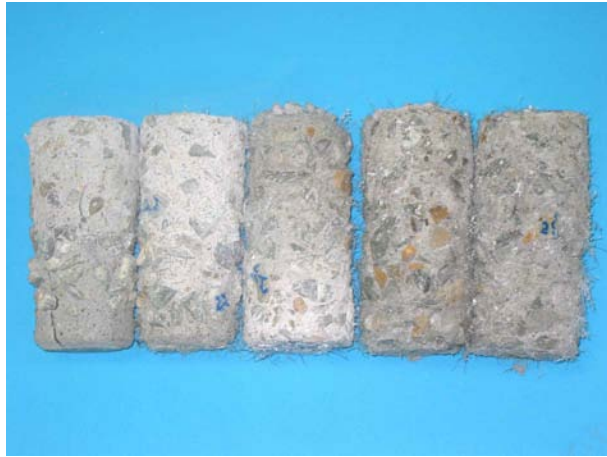
그림 3.2.18 5% 황산 용액에 침적된 시멘트 콘크리트의 중량변화 모습
