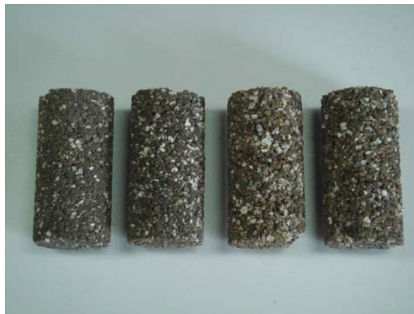
그림 3.2.19 10% 황산 용액에 침적된 포러스 폴리머 콘크리트의 중량변화 모습
