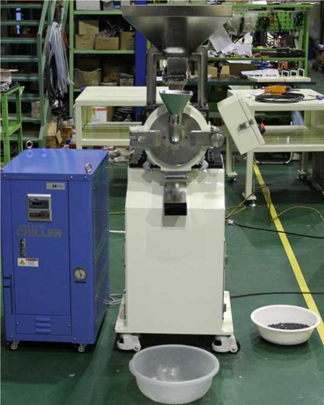
<300mesh급 분쇄기 시제품 제작 완료 사진>
