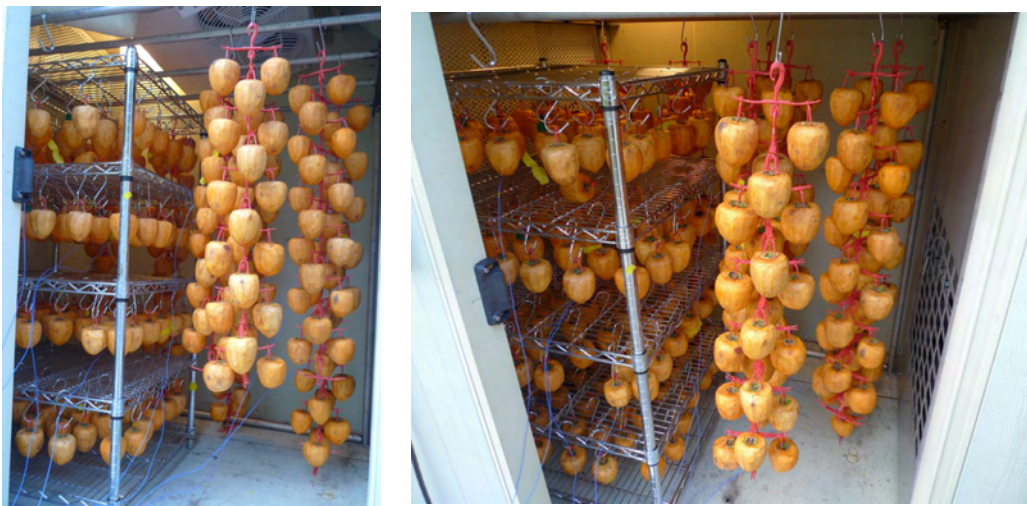
그림 1-34. 차압송풍건조기 내 채반걸이식 건조 중인 꽃감
