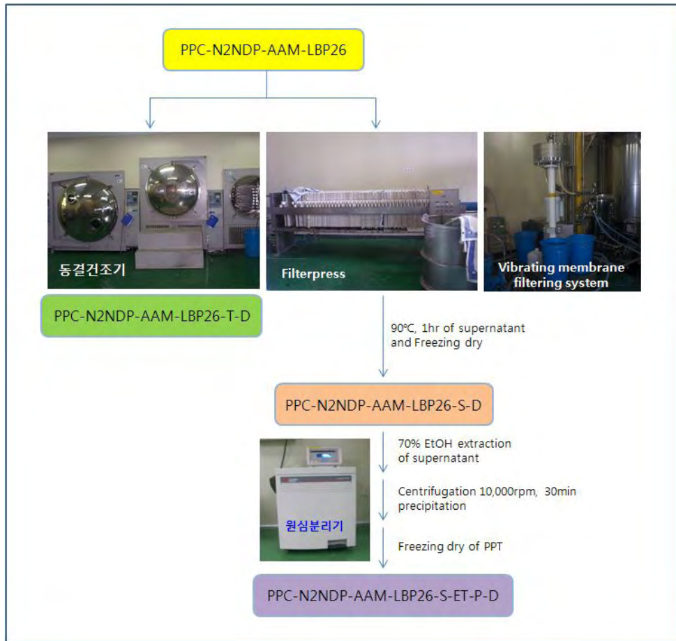
그림 55. Manufacturing process scheme of bioconversion products.
