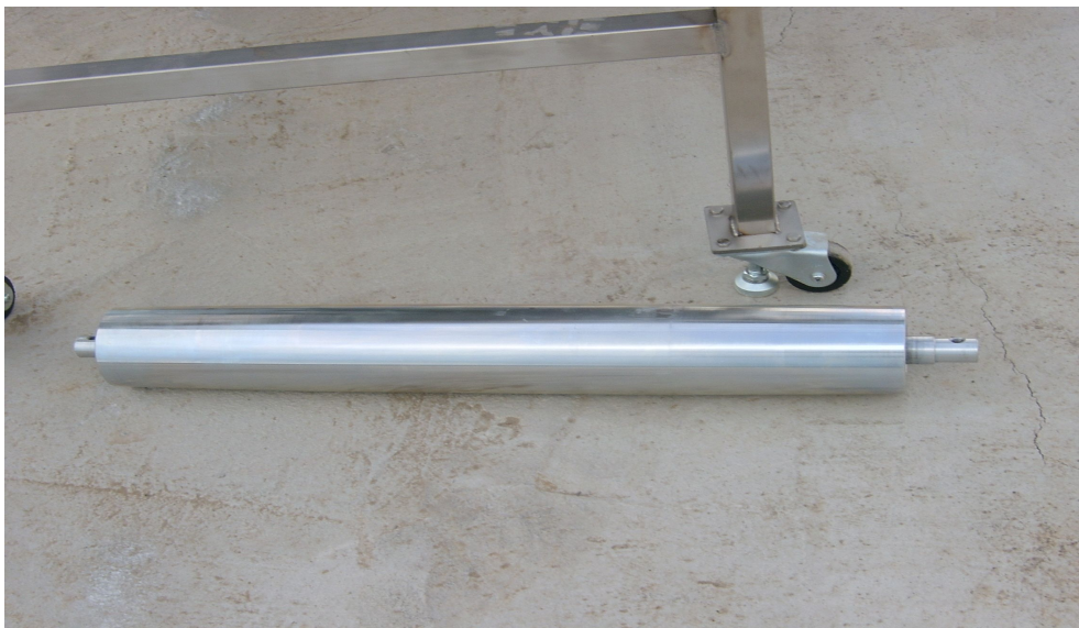
그림 1-11. 가축분뇨 분해용 자동시스템 컨베이어 ROLL부(ALL AL).
