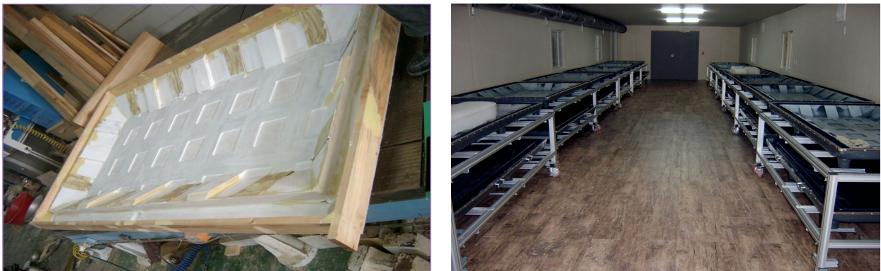
그림 1-43. 동애등에 사육용기 금형및 다단시스템제작.
