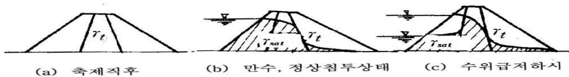
그림 4.9.1 필댐의 자중에 의한 하중을 계산할 때의 단위체적중량을 취하는 방법
