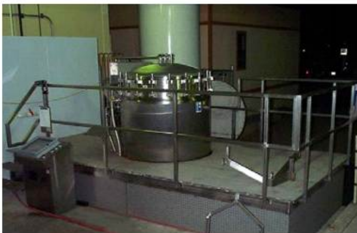
그림 1. 2000 파운드 용량의 알카리 가수분해 조직 처리기의 예시 (Powers, 2003)
