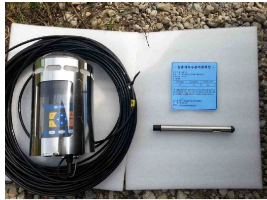
(b) 센서, RTU, 전원공급장치, 케이블 준비
