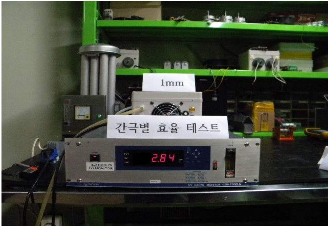
<그림 16> 1.0mm 간극 방전모듈 오존 출력 측정
