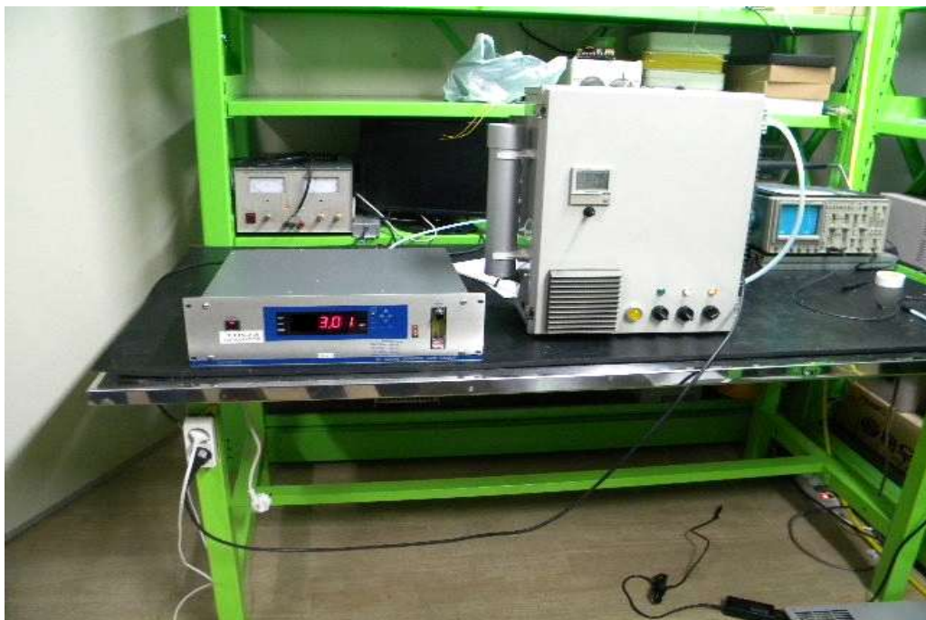
<그림 33> 소비전력 측정 시험
