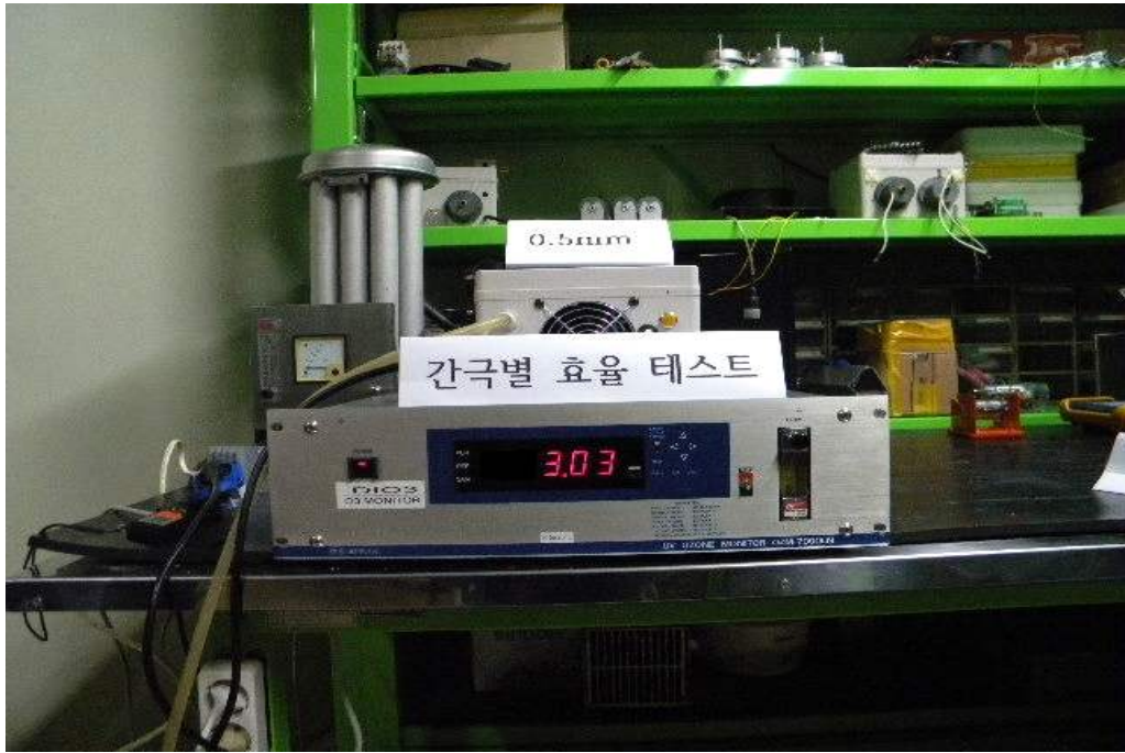
<그림 32> 오존 출력 측정 시험
