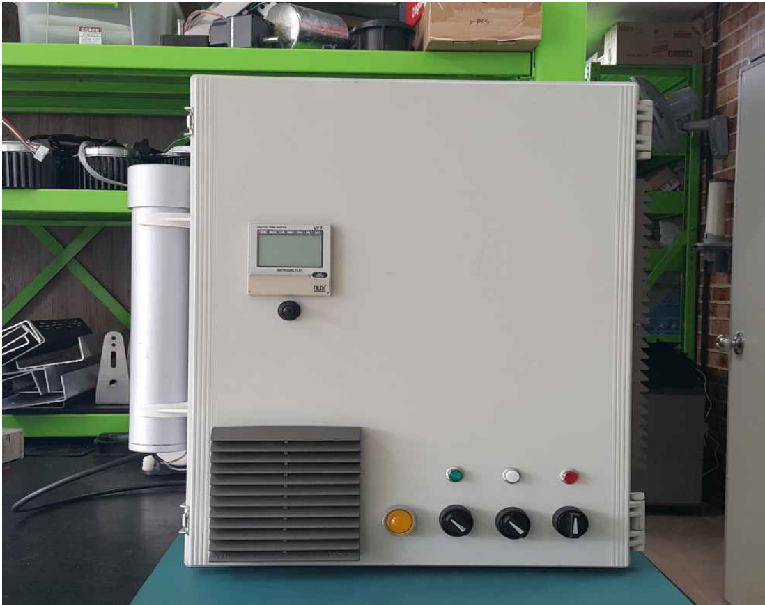
<그림 28> 오존발생기 Pilot 완성품 사진(전면부)
