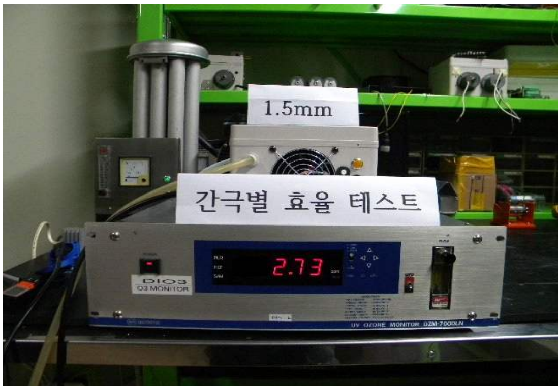
<그림 15> 1.5mm 간극 방전모듈 오존 출력 측정
