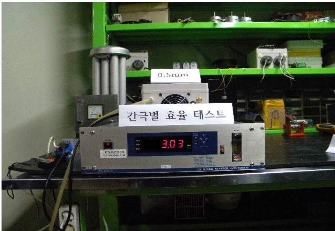
<그림 17> 0.5mm 간극 방전모듈 오존 출력 측정
