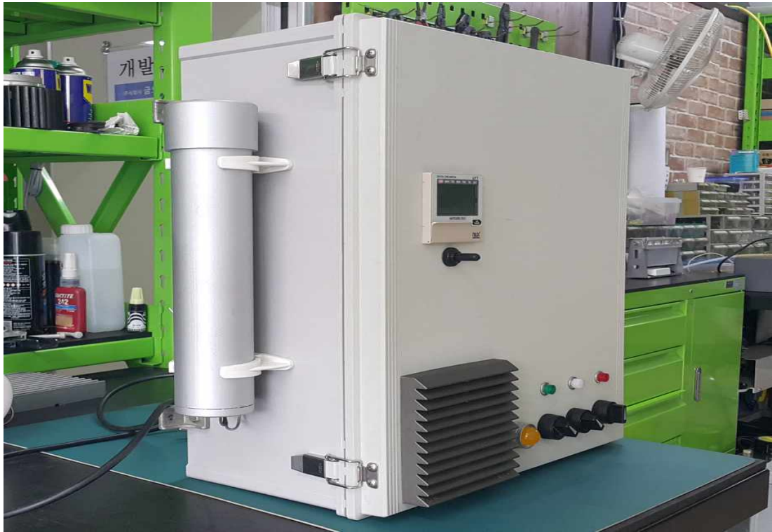
<그림 29> 오존발생기 Pilot 완성품 사진(좌측면부)
