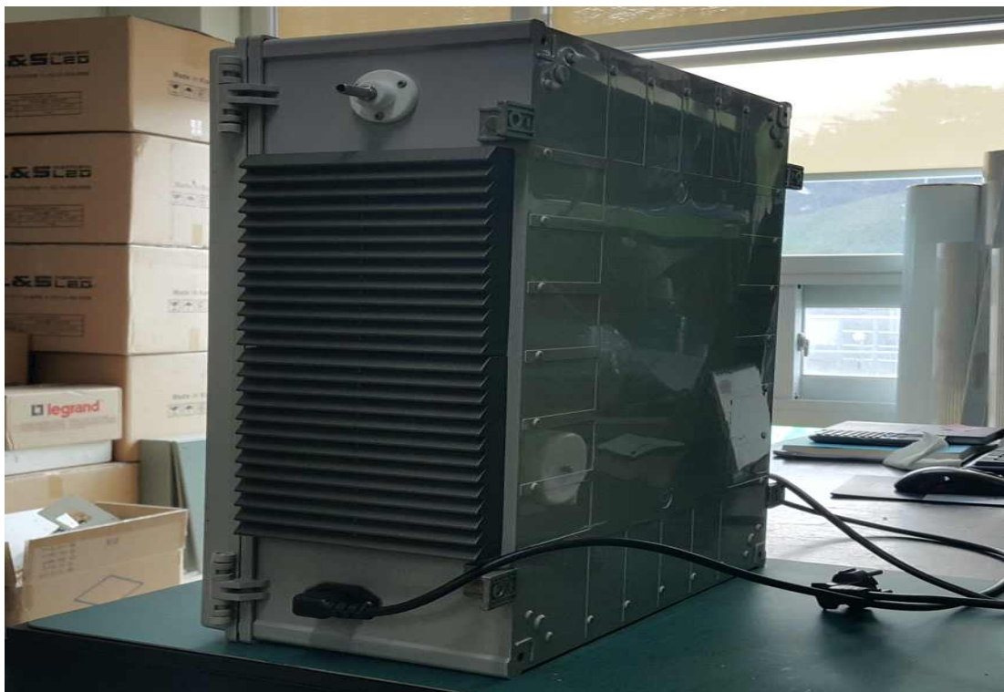
<그림 30> 오존발생기 Pilot 완성품 사진(우측면부)
