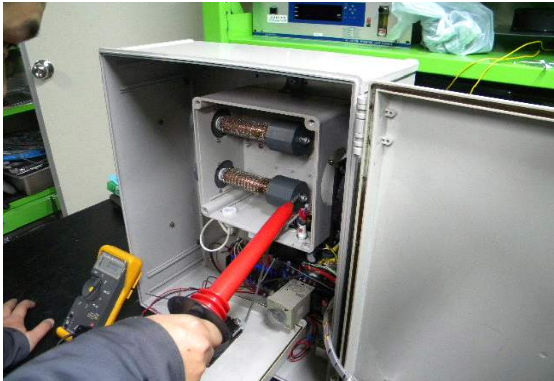
<그림 34> 입력 전압 측정 시험
