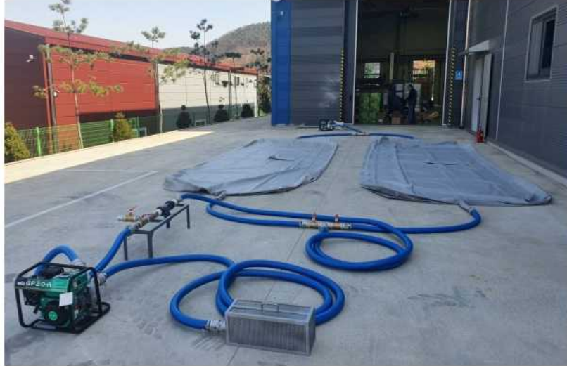
▲ 팩 하나에 최대 10t의 물을 저장할 수 있는, 이동식 저수조 물주머니 모습. 사진=공주시
