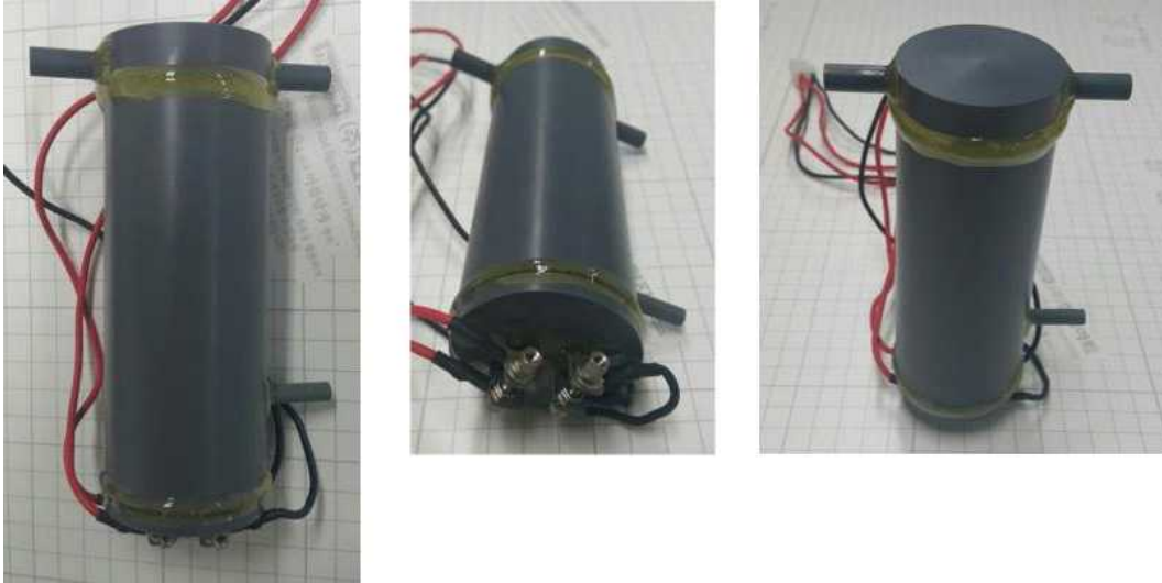
그림52. 전해조의 전원 공급 케이블 결선 조립
