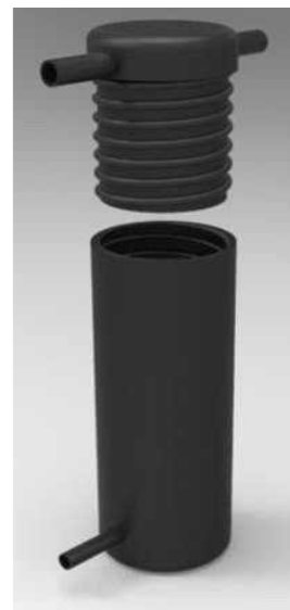
그림49. 전해조 터짐 방지를 위한 스크류타입 전해조 설계
