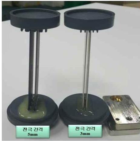
그림23. 전극간격에 따른 제작 설계
