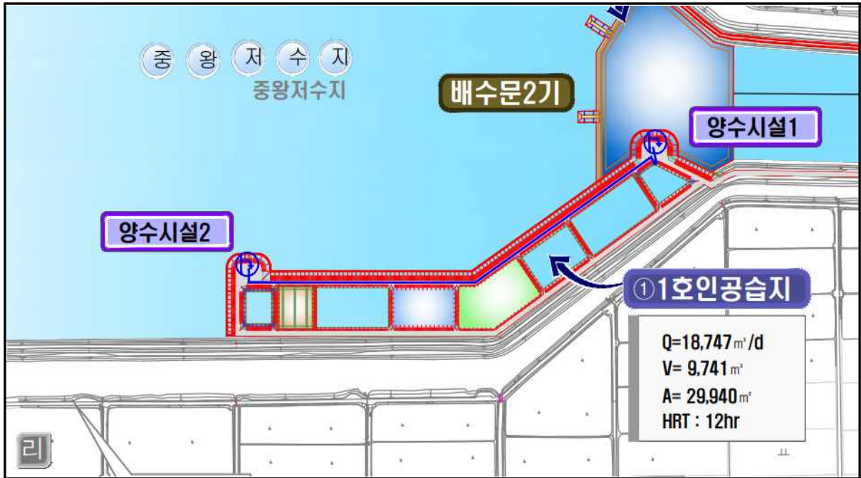
(그림 5.4-5) 양수시설 설치 위치 선정
