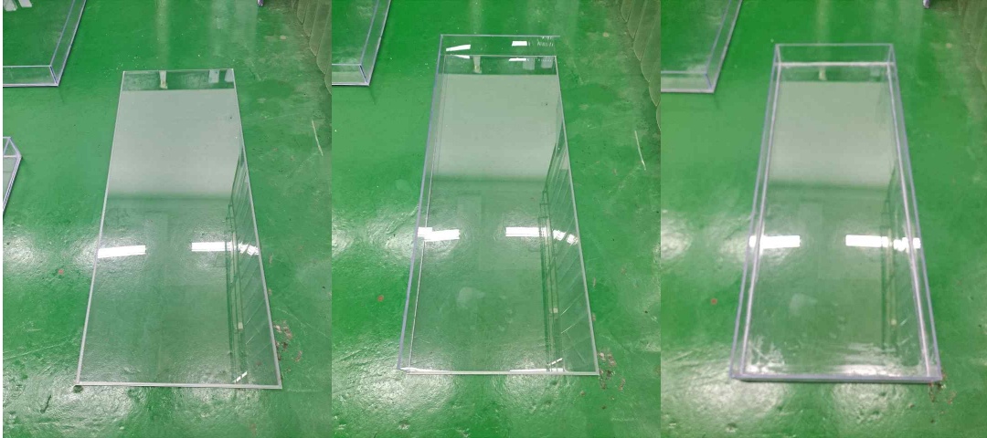
<그림 .2-26> 배드 받침제작(좌), 접착제& 실리콘 방수처리(중), 완료된 배드(우)
