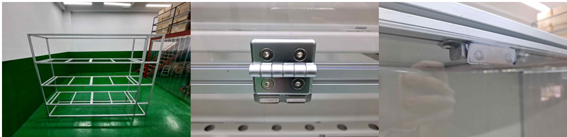
<그림.2-36> 프레임 제작 및 경첩 설치
