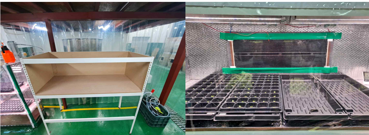
<그림.2-18> 소규모 발아장치 Frame(좌), 난방필름 및 방풍 비닐 부착(우)
