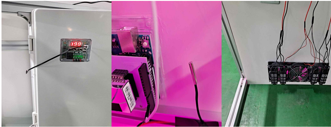
<그림.2-40> 온도 컨트롤러(좌), 수경재배기 온도센서(중), Cooling/Heating Fan(우)
