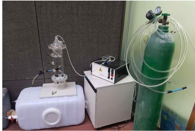
<그림 72. Lab-scale 오존산화실험>
