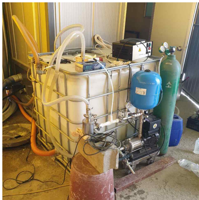
<그림 73. Pilot-scale 오존산화실험>
