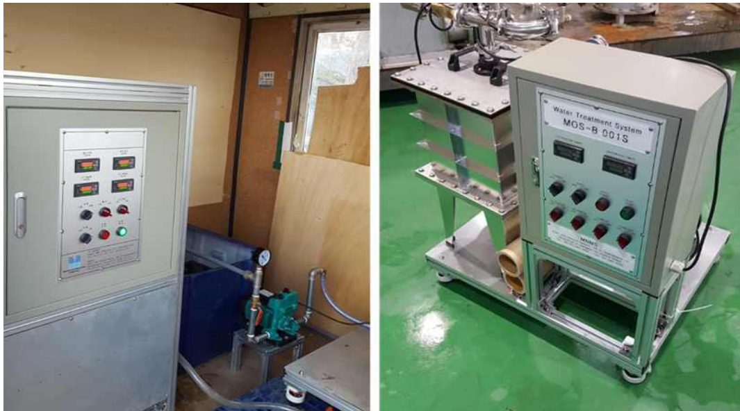
<그림 39. 여과방식 비교실험. (좌)침지식여과, (우)가압식여과>
