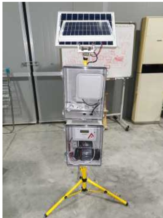
<그림 103. 태양광 전원 공급 및 무선 통신 모듈 구성>
