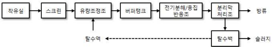
<그림 10. 착유 세척수 처리 시스템 공정>
