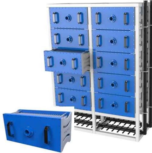
<그림 21. 착유 세척수 처리시스템 막모듈 Scale-up>
