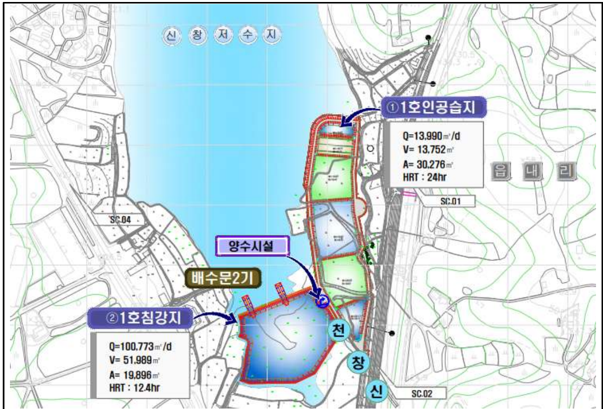
(그림 5.4-4) 양수시설 설치 위치 선정
