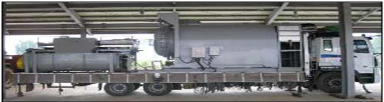
그림 8. 이동식 렌더링 처치장치(열처리장치)
