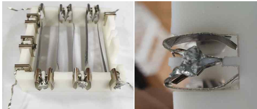
그림 121. (좌) 태양전지 체결된 홈 간격 개선된 모듈 프레임 이미지, (우) 좁은 간격에 의한 프레임 손상
