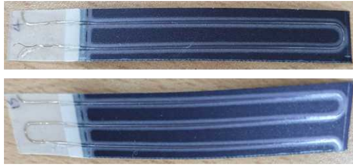
그림 114. 태양전지의 너비에 따른 전면전극의 (상) 1패턴 및 (하) 1.5패턴 구성 이미지
