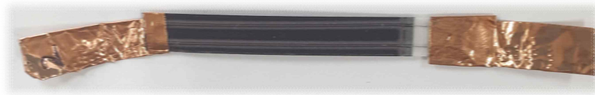
그림 147. 구리 테이프 적용된 단위 태양전지 사진
