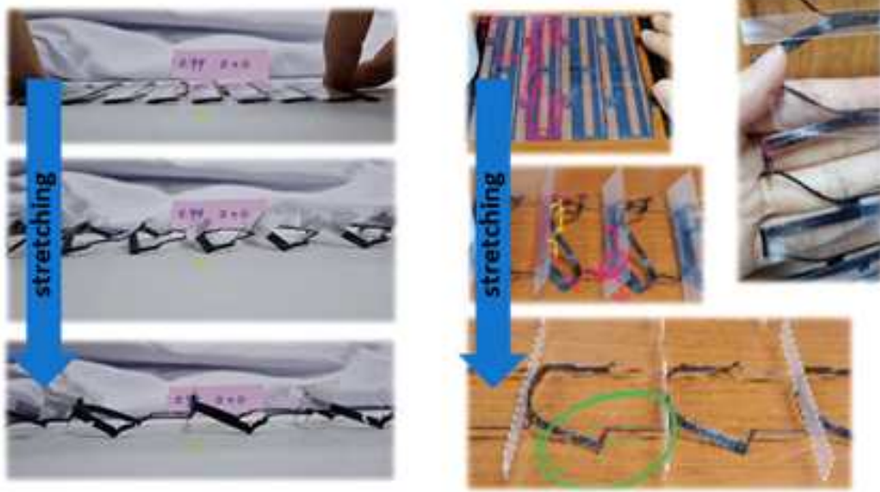
그림 109. 인장에 따른 광각 제어 및 구조 변환 인자 제어 최적화
