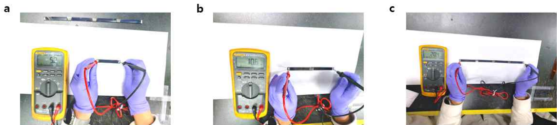
그림 96. 단위 모듈 개수에 따른 저항. (a) 1개, (b) 2개 및 (c) 4개
