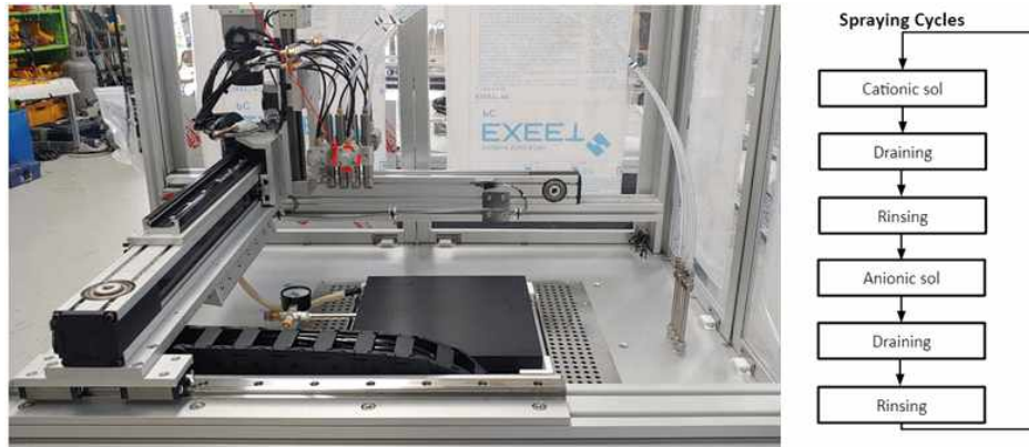
그림 200. 층상 자기조립법 기반 스프레이 코팅 시스템과 단위 코팅 사이클의 모식도
