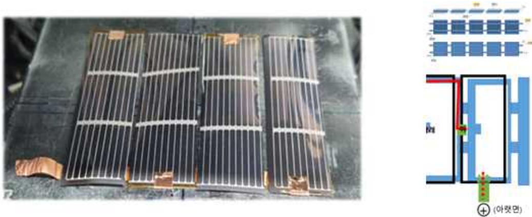
그림 110. 태양전지 모듈의 기계적 메타물질 구조체 상 집적 (기계적, 전기적 연결)
