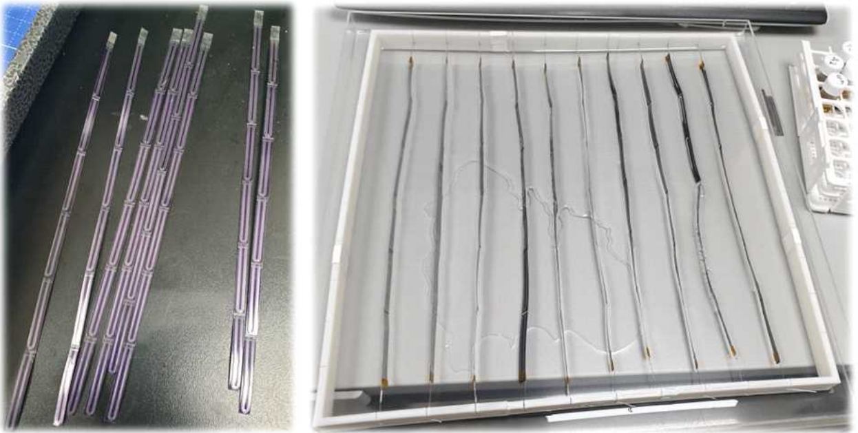
그림 155. 모듈 프레임에 적용하기 (좌)전, (우)후의 단위 태양전지 이미지. 프레임에 체결 후 고정을 위해 레진을 바닥에 도포함
