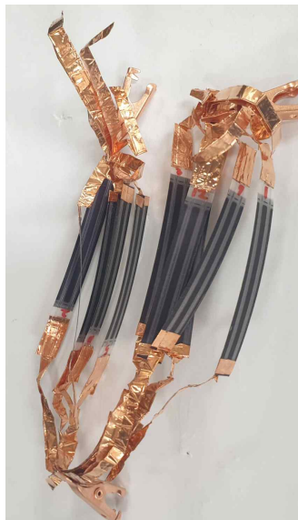
그림 145. 병렬-직렬 연결된 단위 태양전지 사진
