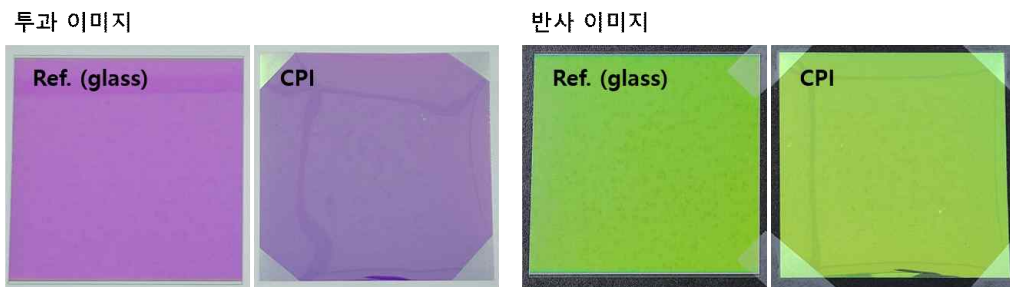
그림 226. 유리기판과 CPI 필름 상에 제작된 이색성 광필터. (좌) 투과이미지, (우) 반사이미지.
