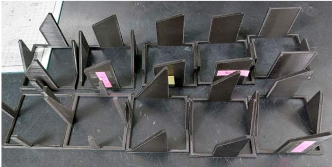
그림 182. 입사광 각도별( 0^{\circ} - 90^{\circ} ) 태양전지 효율 측정용 프레임 이미지
