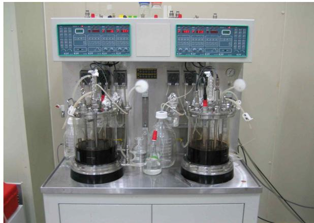
그림 65. 실험에 사용한 jar fermentor (5 liter 규모)의 모습
