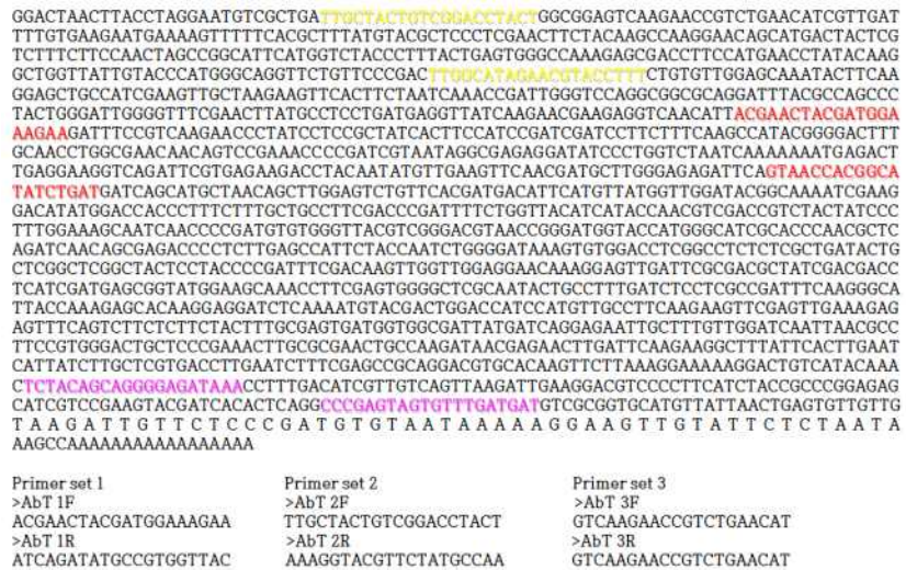
그림 29. Tyrosinase coding gene을 증폭하기 위한 real-time RT PCR용 primer 제작.
