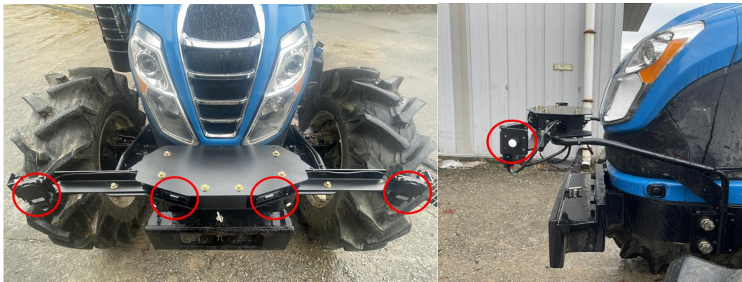
<좌> 4개의 Radar 시스템 설치 (우) 4개의 초음파센서 설치>
