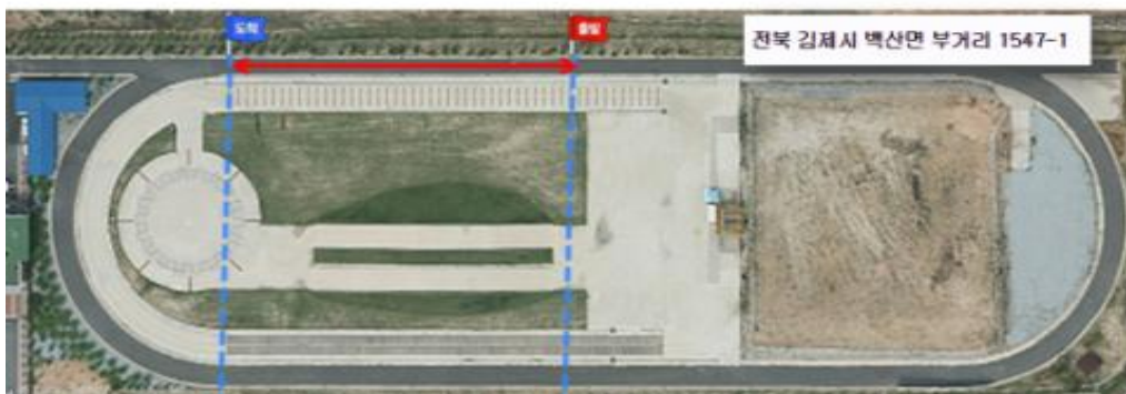
추종오차를 측정하기 위한 원형 트랙 및 측정위치
