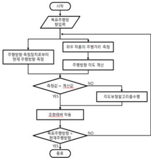
자율주행 콤바인의 조향제어시스템 구성도 및 제어흐름도
