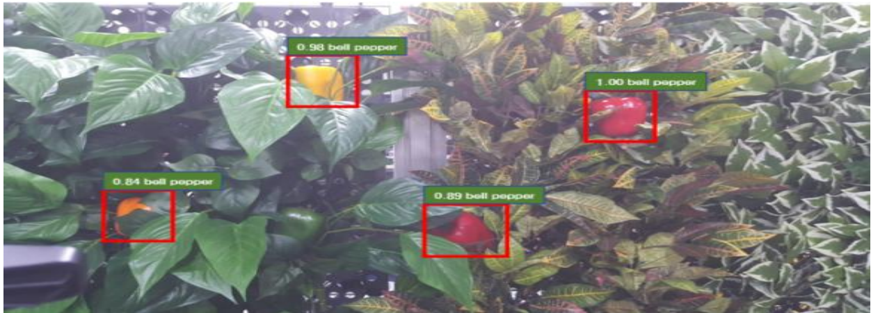
<Faster Rcnm 모델을 통한 Bell Pepper Detection결과(실제 테스트)>
