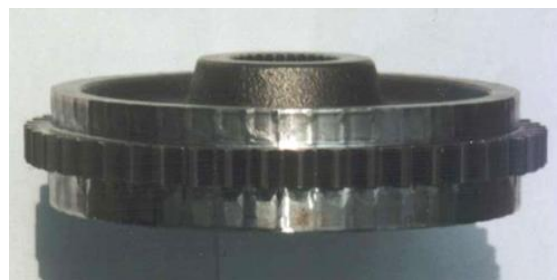
그림2. PTO driving gear used in the fatigue life test
