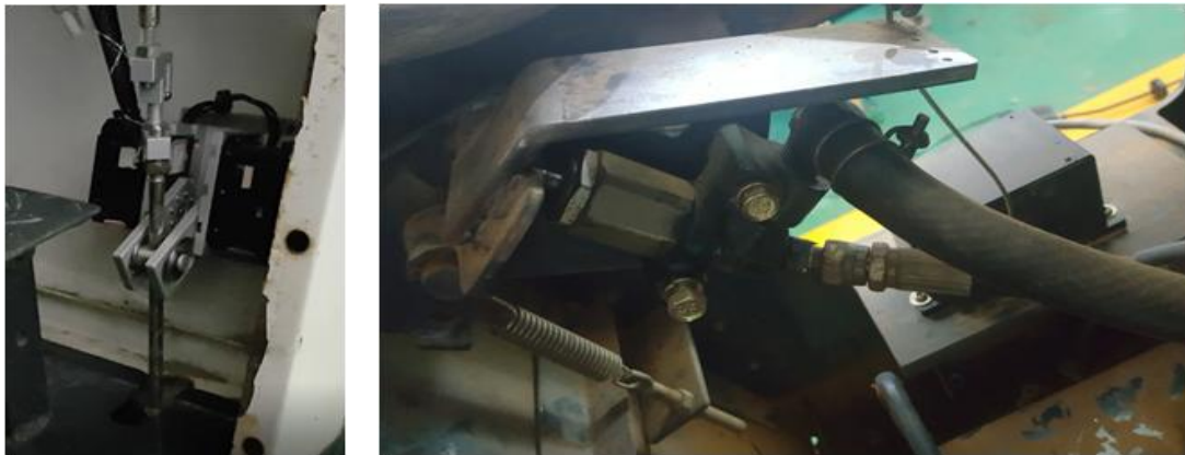
조향제어 Actuator(좌-변경 전, 우-변경 후)
