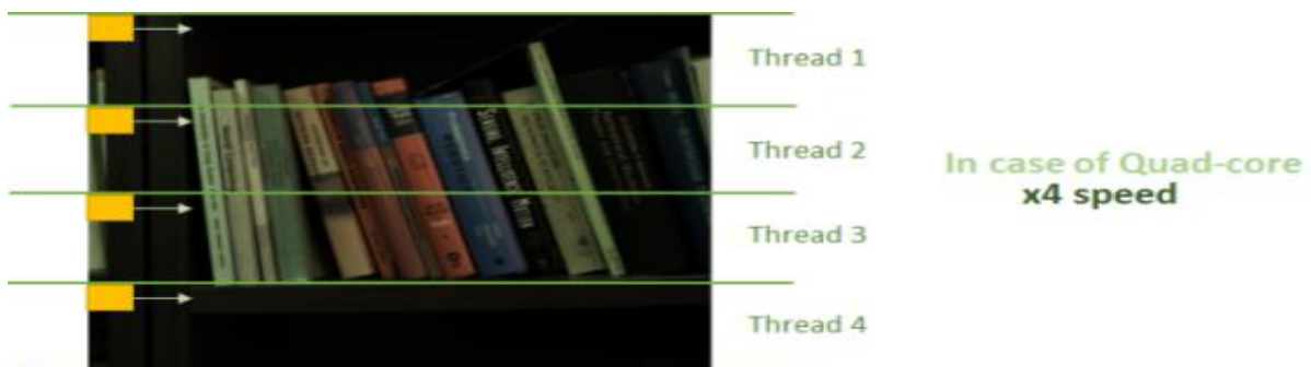
<쿼드코어의 경우 Multi-threading을 이용한 스테레오 매칭 병렬처리 예시>
