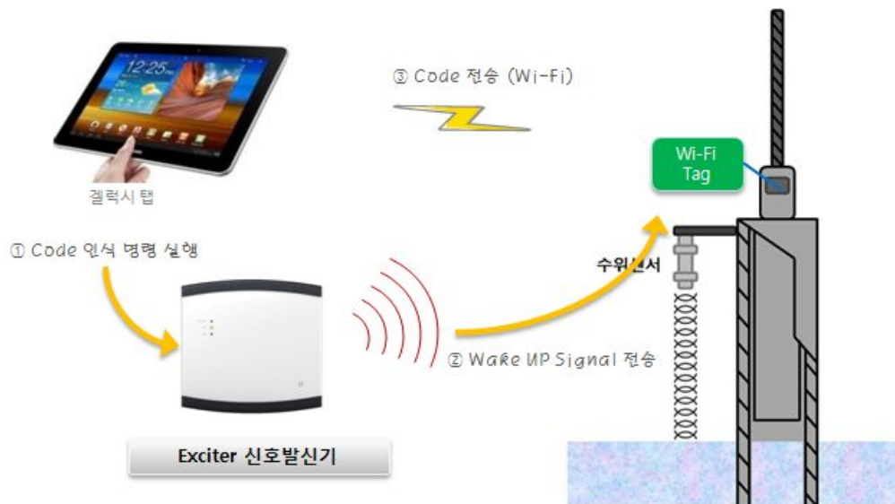
<그림 2-1>Wi-Fi Active Tag 시스템 구성
