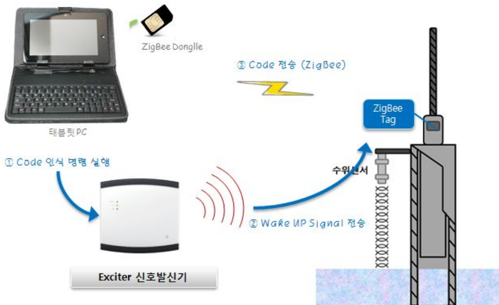
<그림 2-16> ZigBee Active Tag 구성도
