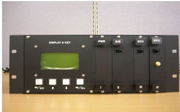
<그림 3-56> 유량계 컨트롤러
