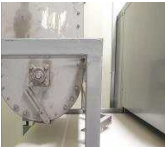
그림 35. 생산현장에 적용된 분말두께 조절용 장치 및 컨베이어 벨트
