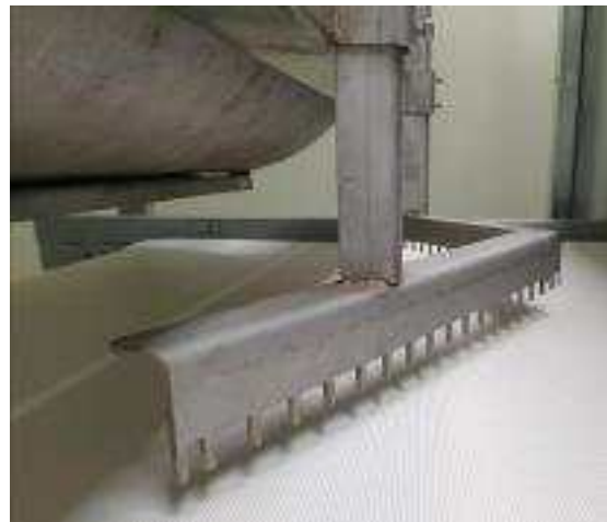
그림 35. 생산현장에 적용된 분말두께 조절용 장치 및 컨베이어 벨트
