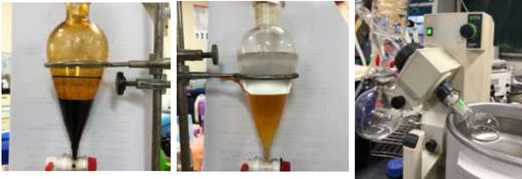
그림 136. Vitamin D2 전구체 추출을 위한 버섯 추출 용매 및 농축
