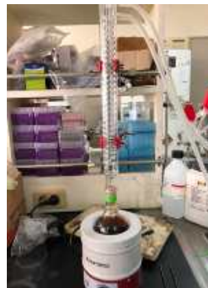
그림 16. 버섯 시료를 이용한 비타민 D2 전구체 추출
