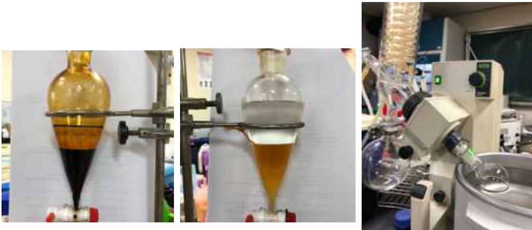
그림 17. Vitamin D2 전구체 추출을 위한 버섯 추출 용매 및 농축
