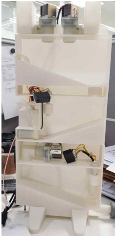
<그림 75> 조립 중인 농약정량공급기와 완성된 농약정량공급기
