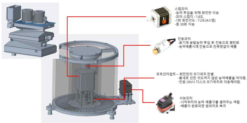
< 그림 44> 기초 설계상의 분말 농약공급기 구성도 개요
