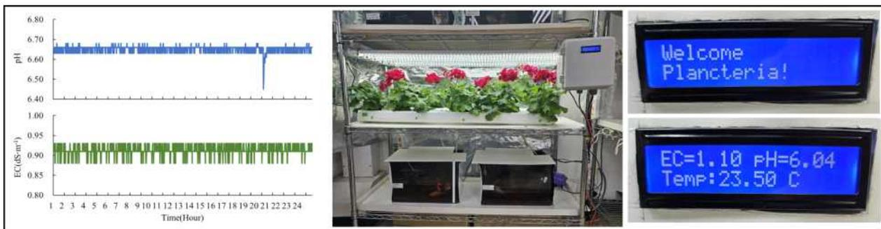
그림 3-8-4. 센서 보정 과정 중 배양액 pH와 EC 모니터링
