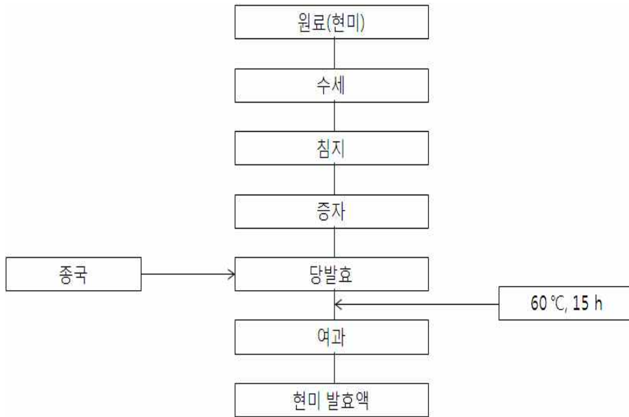
그림 8. 현미발효액의 제조공정 모식도.
