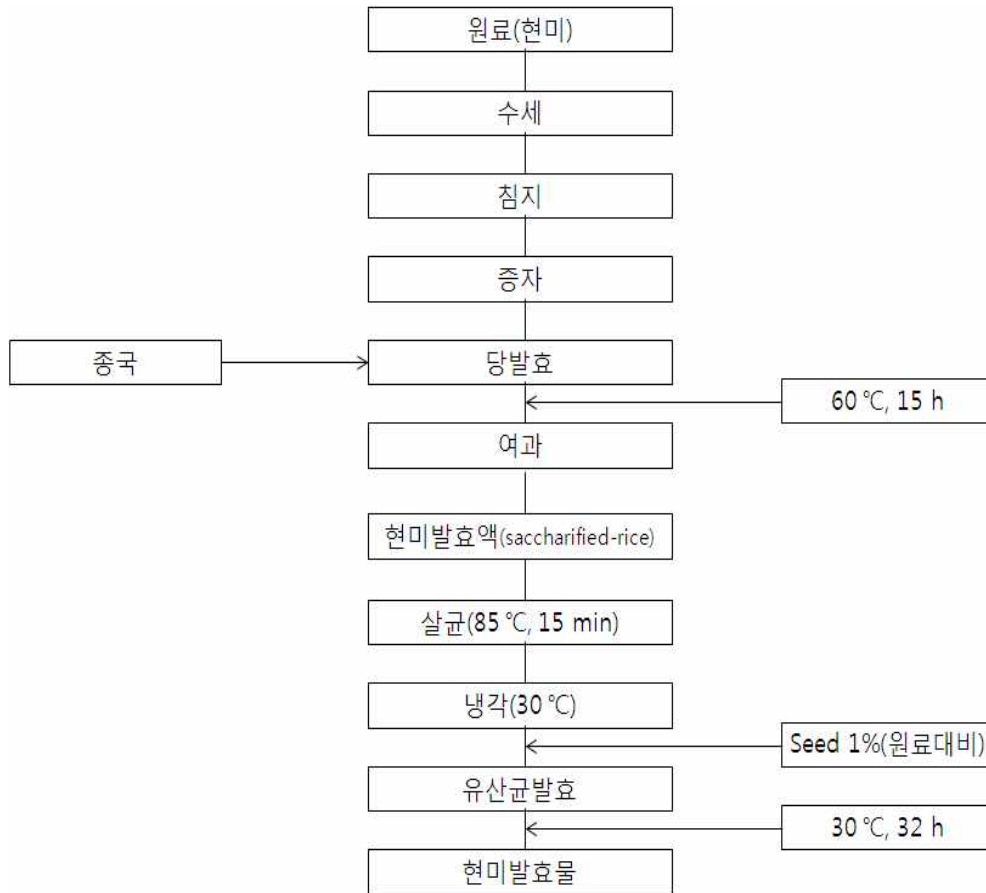
그림 15. 현미발효물의 제조 공정 모식도.
