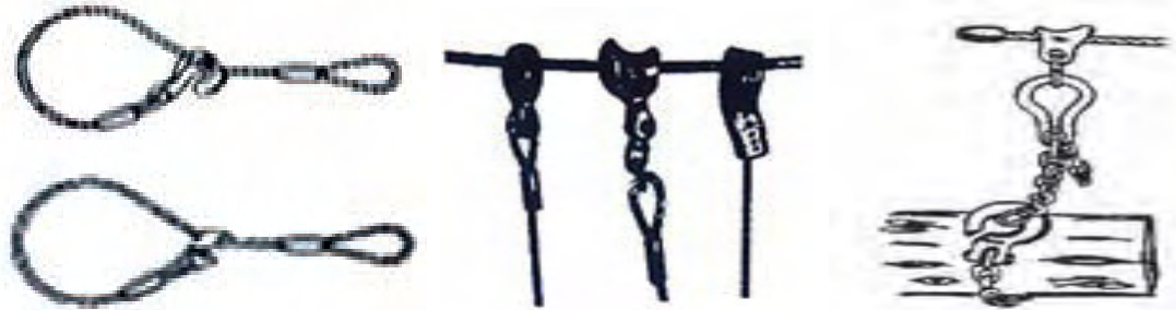
그림 122. 띠쇠줄(와이어로프) 그림 123. 초커(3개 장착) 그림 124. 초커(1개 장착)
