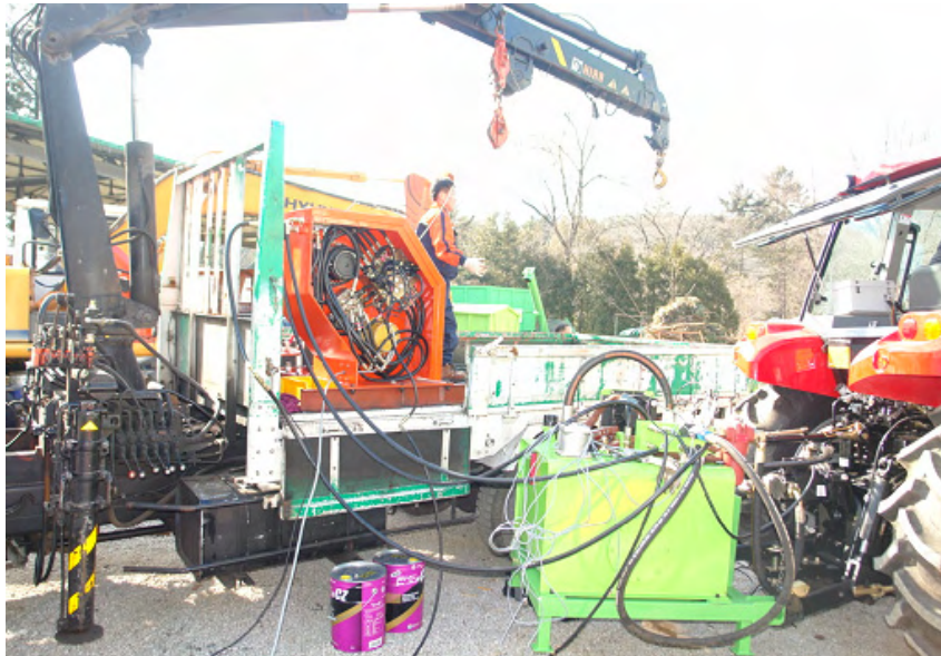
그림 31. 자동 장력 조절형 집재윈치 시작기의 시험
