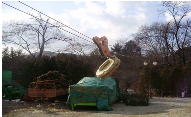
그림 48. 유압 시스템을 이용한 목재반송기 구동 모습
