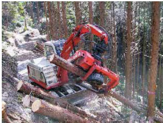
그림 179. 임내작업차도 (폭 2~2.5m)에서의 조재작업 지형이 험한 장소에서는 산방향 (사진)으로 송재
