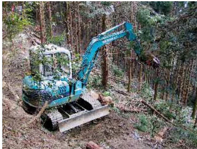
그림 178. 그레플 로더에 의한 나무모으기 작업 임내로망밀도를 높여 나무모으는 거리를 단축
