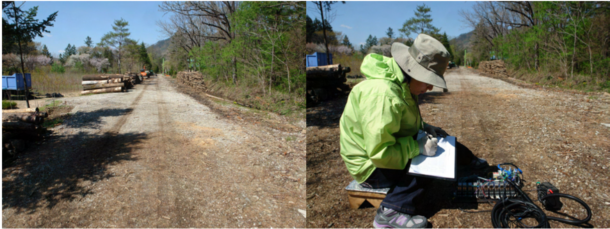
그림 114. 장애물이 없는 8호포지 거리 측정 실험
