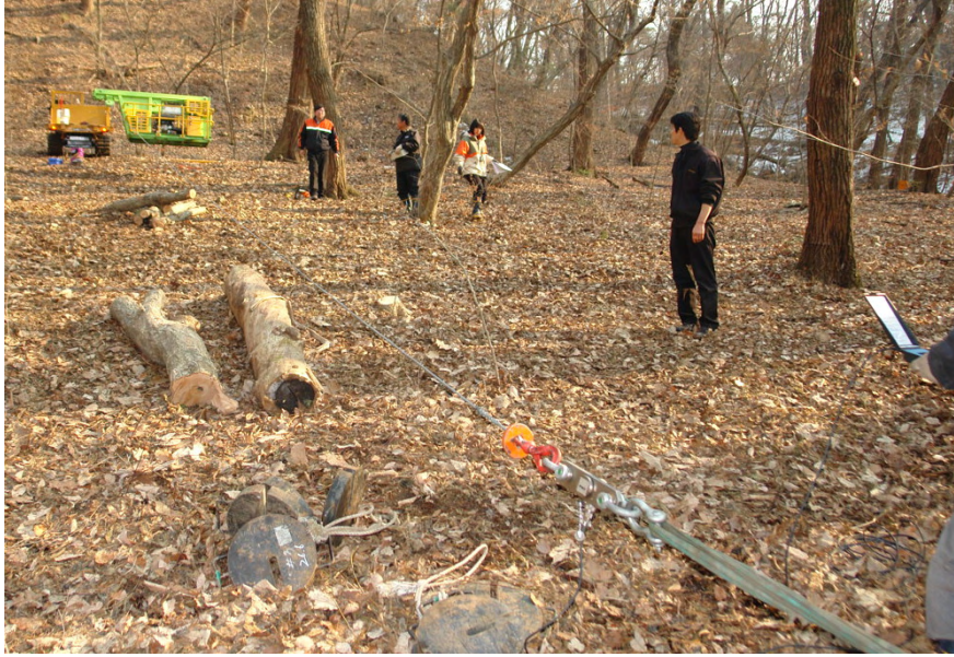
그림 136. 자주식 목재반송기의 횡집재 견인력 측정시험
