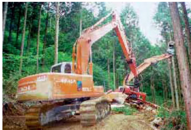
그림 168. 스윙야더와 프로세서의 작업 시스템
