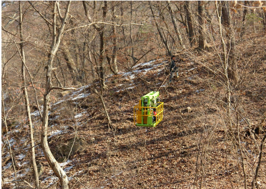
그림 88. 설계 기능 확인 시험(경사지 주행)
