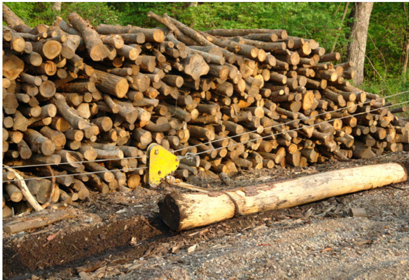
그림 60. 견인력 및 견인속도 측정 실험
