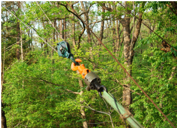
그림 59. 견인력 측정 장치
