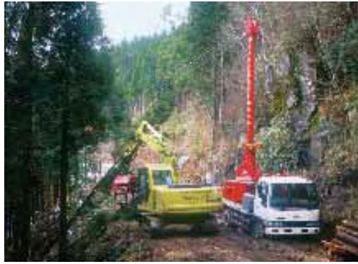
그림 164. 주삭식 타워야더와 프로세서 작업시스템
