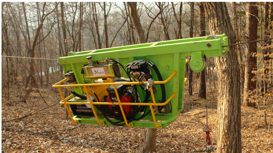
그림 87. 개발된 무선조종형 자주식 목재반송기
