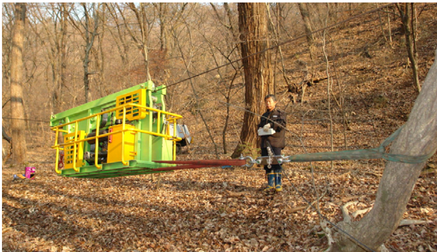
그림 137. 자주식 목재반송기의 주행견인 측정시험
