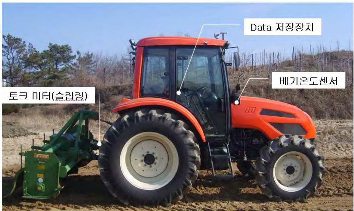
<그림 3-58> 로터리 작업 시험 트랙터의 시험 장치
