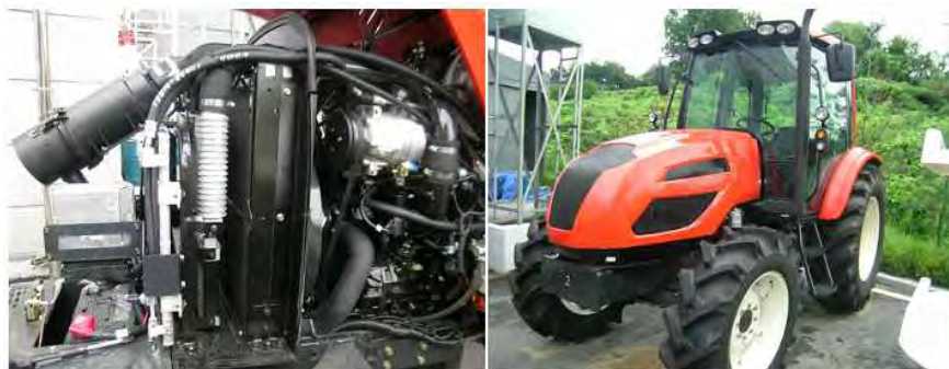
<그림 2-18> Cooling Module 및 과제수행용 시제품 트랙터
