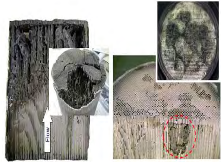
<그림 4-7> Maximum filter Temperature & 필터의 용융
