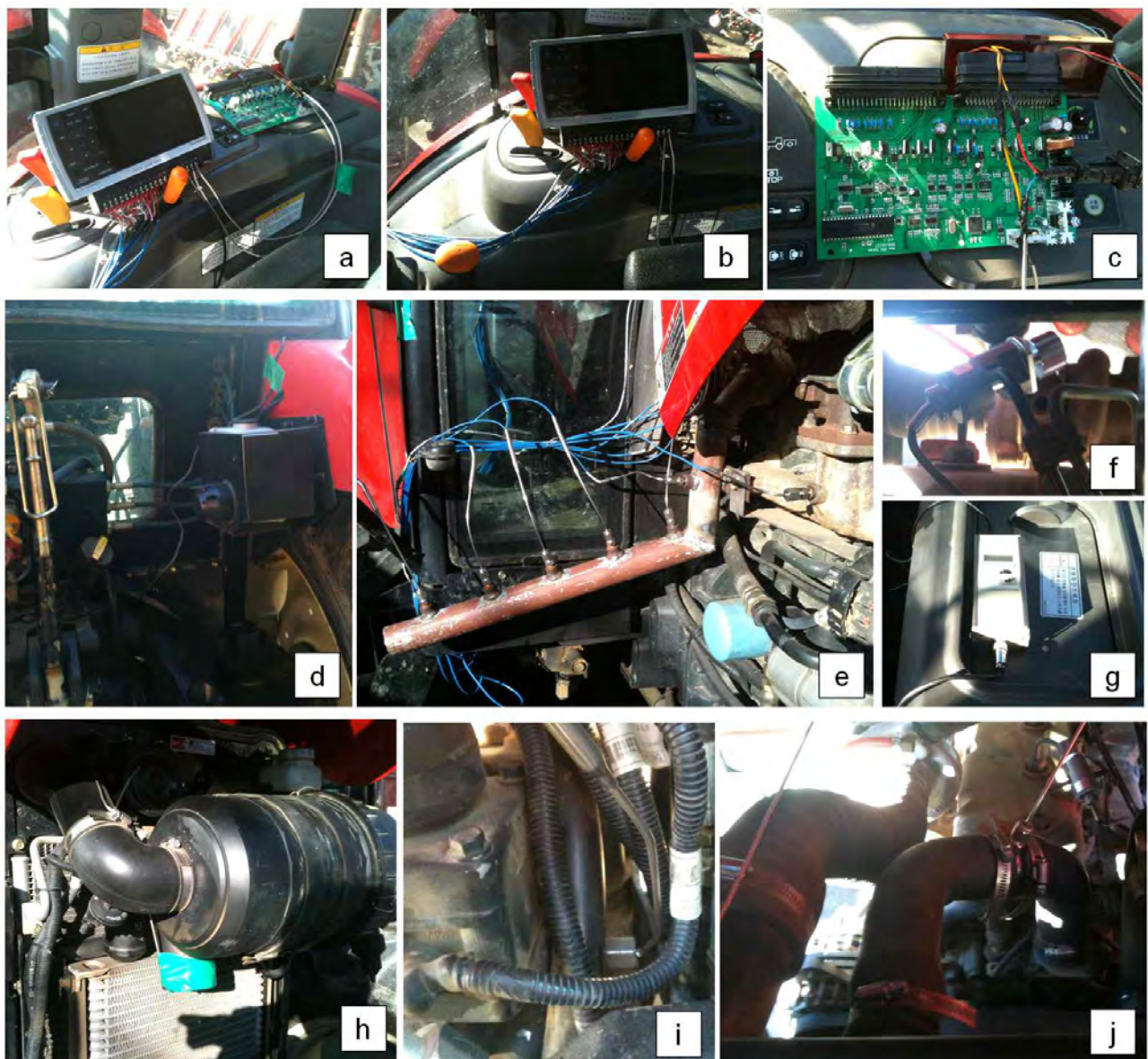
<그림 3-37> 트랙터에 장착된 센서 및 계측장비
