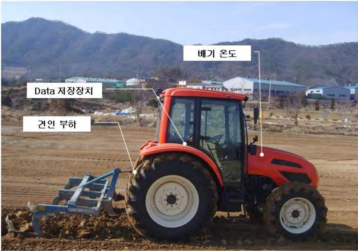
<그림 3-63> 쟁기 작업 시험 트랙터의 시험 장치
