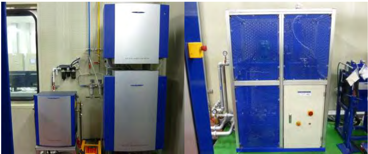
<그림 4-47> 연료 공급 / 소모율 측정장치 및 냉각수 온도 제어장치
