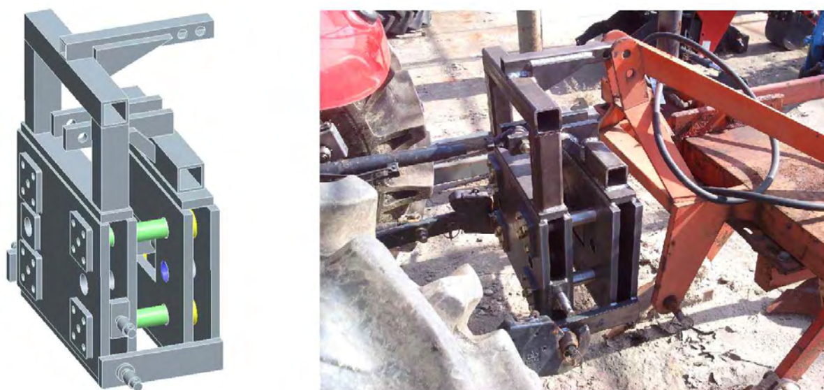
<그림 3-29> 플라우 부하측정기 모델링 및 형상
