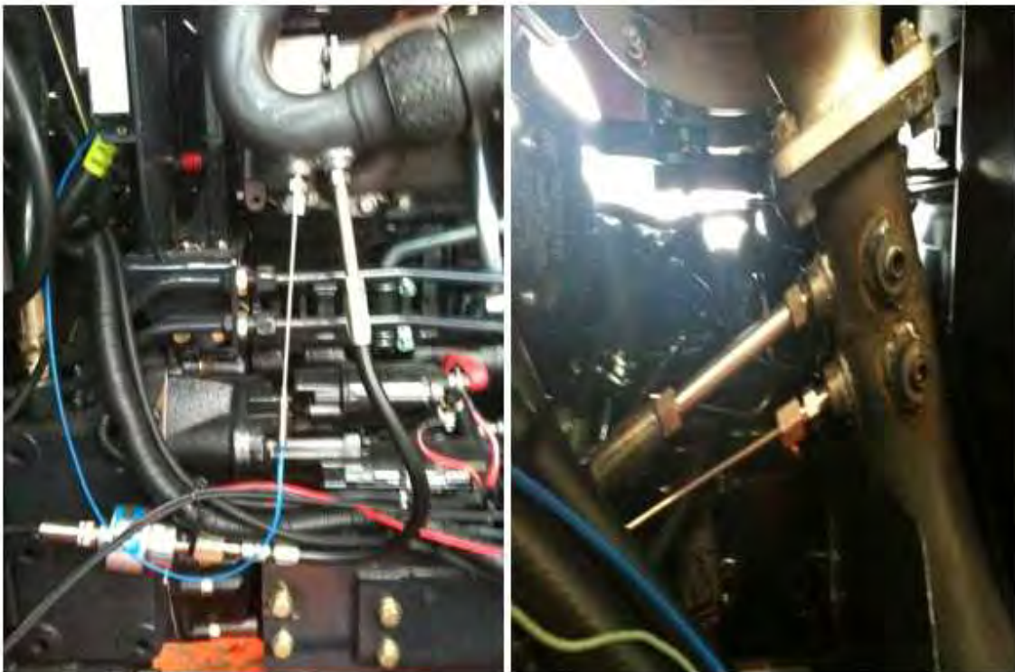
<그림 3-54> 주행 시험 시 사용된 배기 온도 센서
