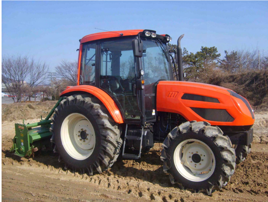
<그림 4-94> 최종 시제품 트랙터의 실포장 작업 시험
