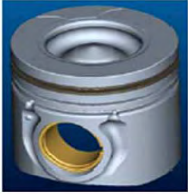
<그림 3-5> 피스톤에 위치한 Bowl과 연료 분사 형상 (6홀 Nozzle)
