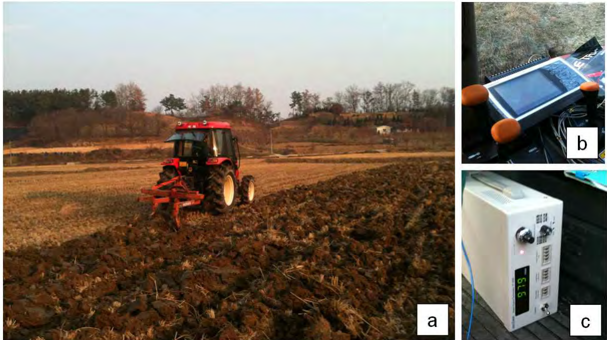
<그림 3-31> 쟁기부하측정 작업 모습(a)과 측정 장비(b: 데이터 저장장치, c: RPM측정기)
