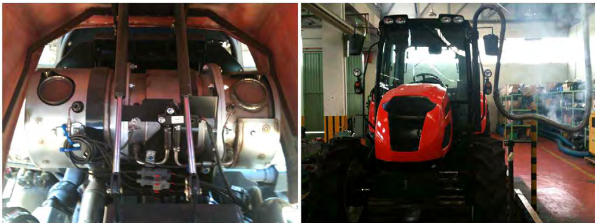
<그림 3-41> 트랙터에 탑재된 DPF와 재생하는 모습
