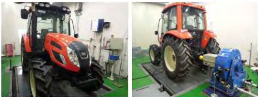
<그림 2-29> Dynamo와 시제품 트랙터와의 Matching
