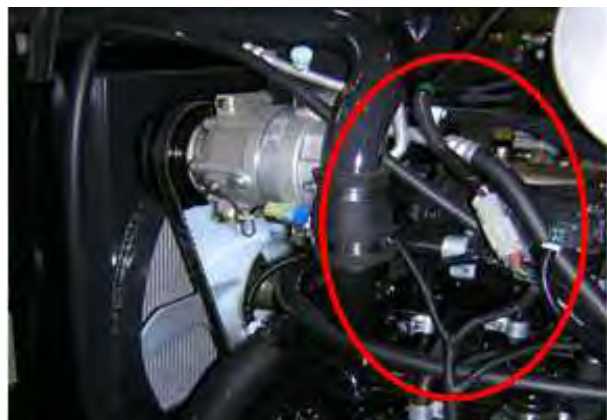
<그림 1-46> 엔진룸 호스 및 케이블류 배치
