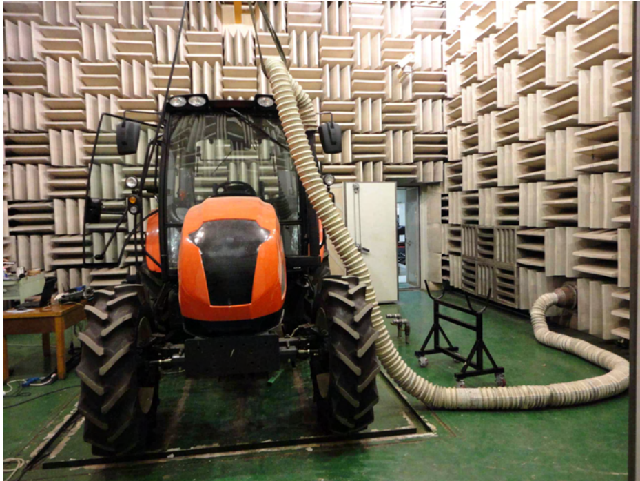
<그림 1-65>소음진동 시험 환경
