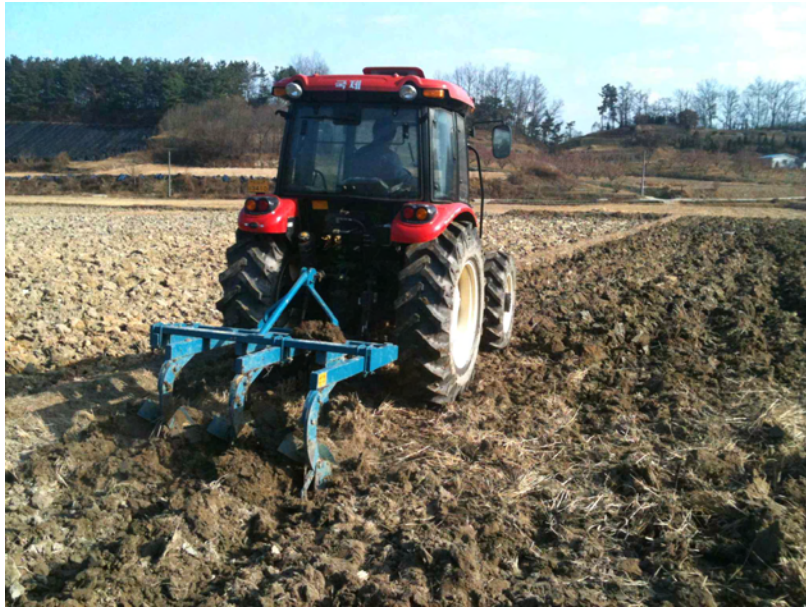
<그림 3-38> 실제 경작지에서 쟁기작업을 하는 모습
