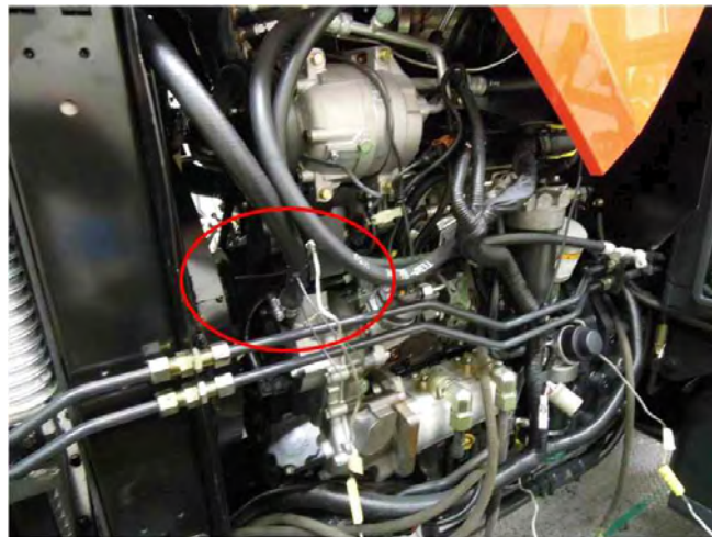
<그림 1-98> 엔진내부온도 측정>
