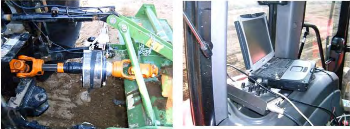
<그림 3-59> 로터리 작업 시험에 장착된 부하측정기 및 저장 장치
