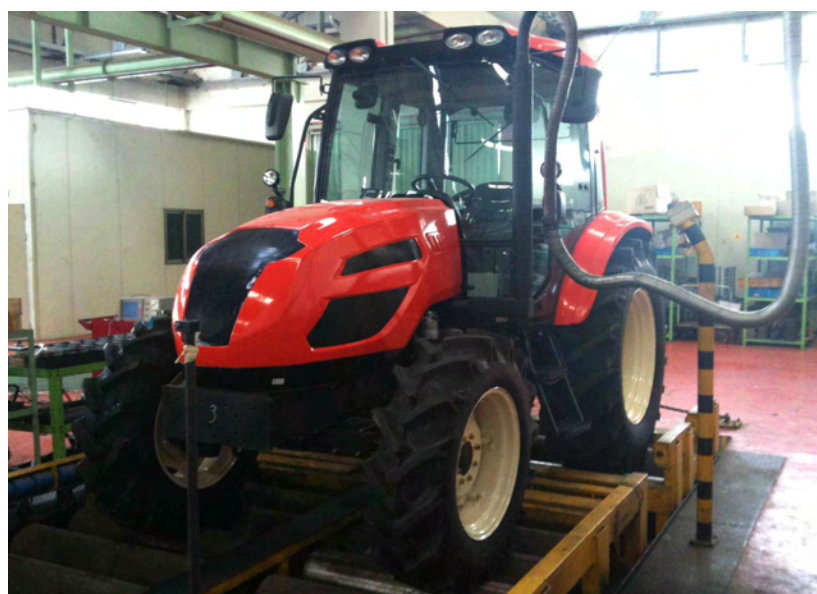
<그림 3-48> 트랙터 주행시험기에서 주행 시험 중인 트랙터
