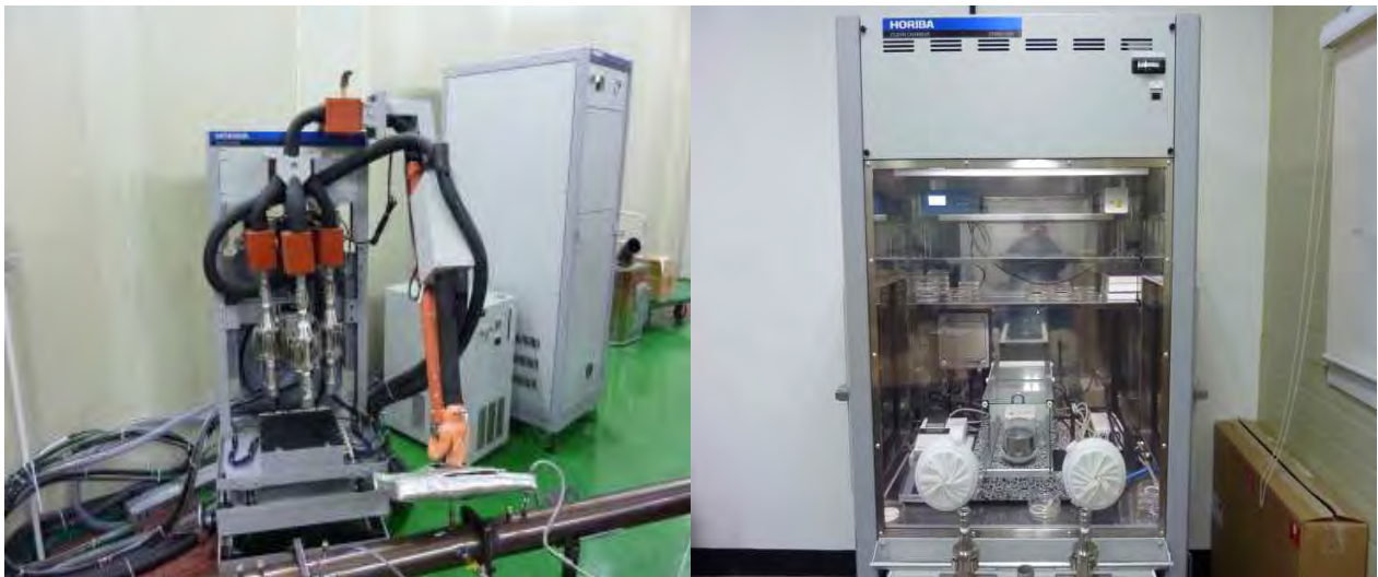
<그림 4-45> 입자상물질 포집 및 측정장치
