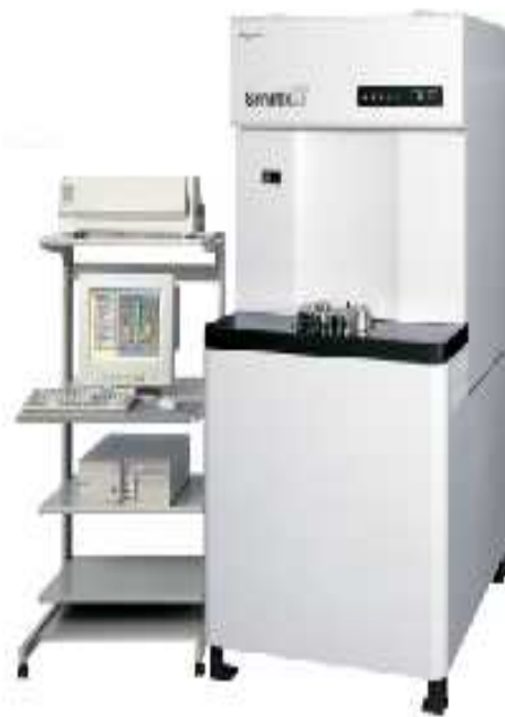
그림 53 성분분석 장비 (WD-XRF)
