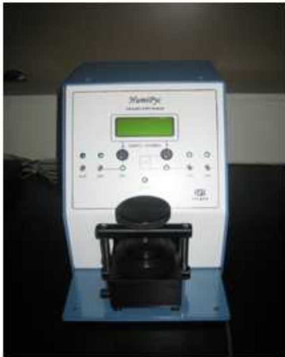
그림 52 밀도측정 장비 (Gas pycnometer)
