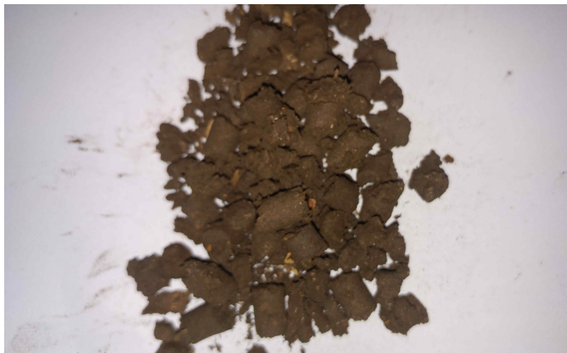
그림35. 목재펠릿성형기(E-150)를 이용한 커피유 첨가 팽연왕겨 펠릿
