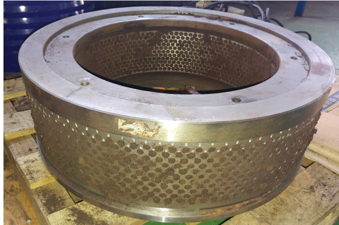
그림45. 커피유첨가 팽연왕겨 pellet mill ring die
