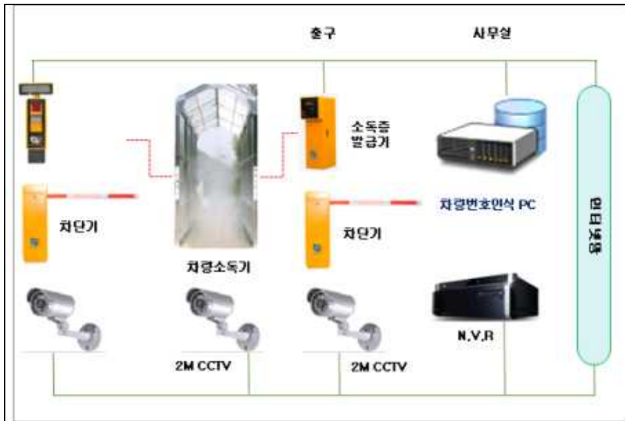
<그림 54> 소독시설 내 CCTV 모니터링 시스템 모식도
