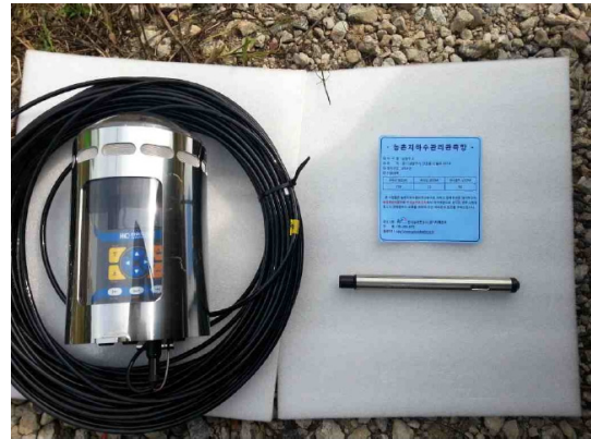
(b) 센서, RTU, 전원공급장치, 케이블 준비
