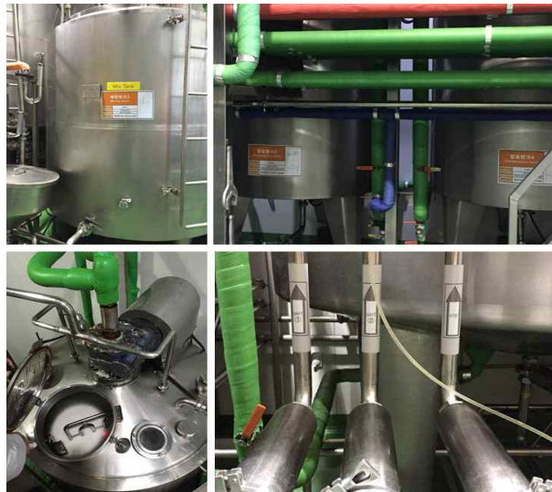
그림 1-44. 발효 당화유단백질 적용 발효유 및 발효음료 Pilot scale 제조 공정 (왼쪽 위: 배합탱크, 오른쪽 위 발효탱크, 왼쪽 아래: 혼합, 오른쪽 아래: 살균)
