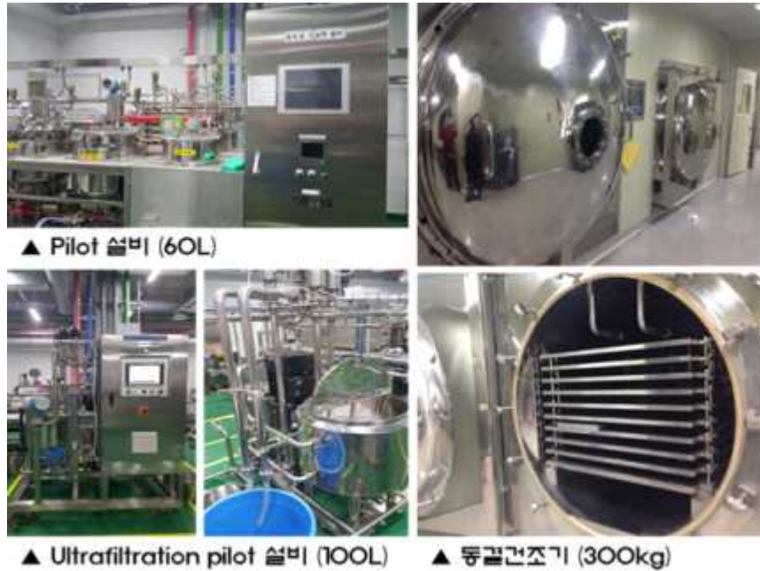
그림 1-4. 당화반응생성물 제조 pilot system
