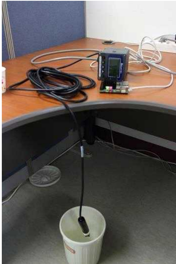
그림 2.6.11. ORP 센서 테스트
