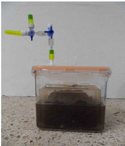
그림 2.1.17. 고상혐기소화 실험장치 및 중온실험용 인큐베이터 사진
