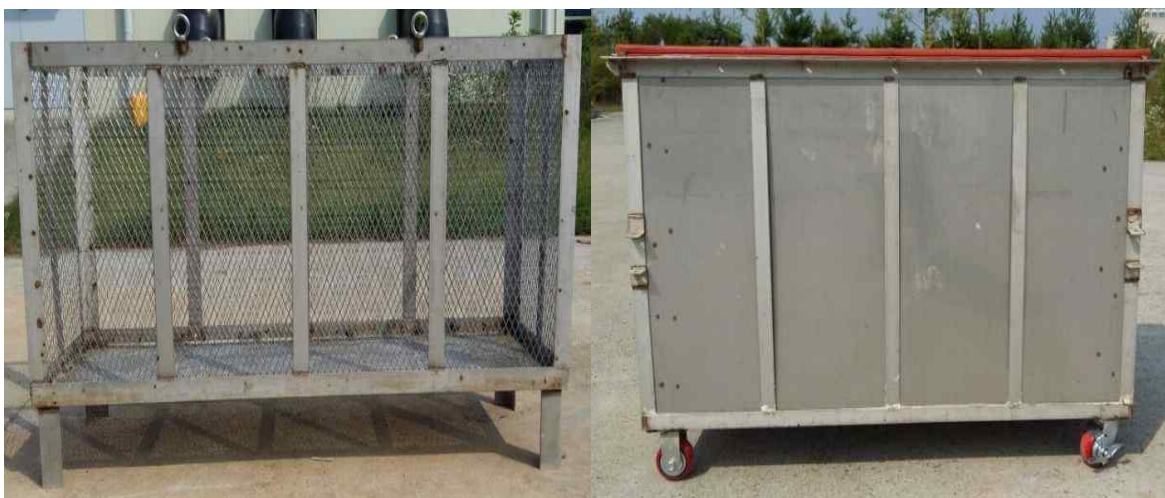
그림 2.1.5. Lab 규모 Pilot 500L 가수분해 및 고상혐기소화 장치(내부 타공망/소화조)
