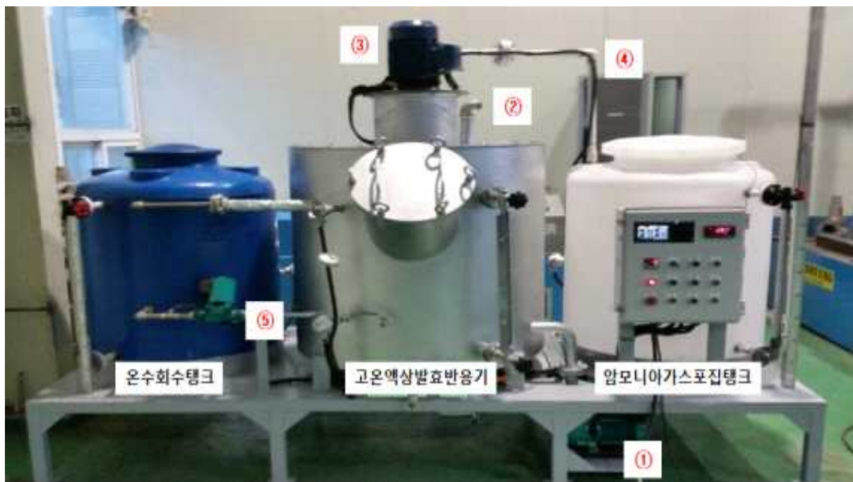
①에젝터펌프, ②공기흡입구, ③소포기모터, ④가스배출구, ⑤순환모터(온수회수) 그림 2.7.101. 고온액상발효반응기 및 열병합(온수회수) 장치
