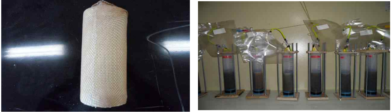
그림 2.1.7. 고상혐기소화 실험장치 내부 여과망 및 설치 사진
