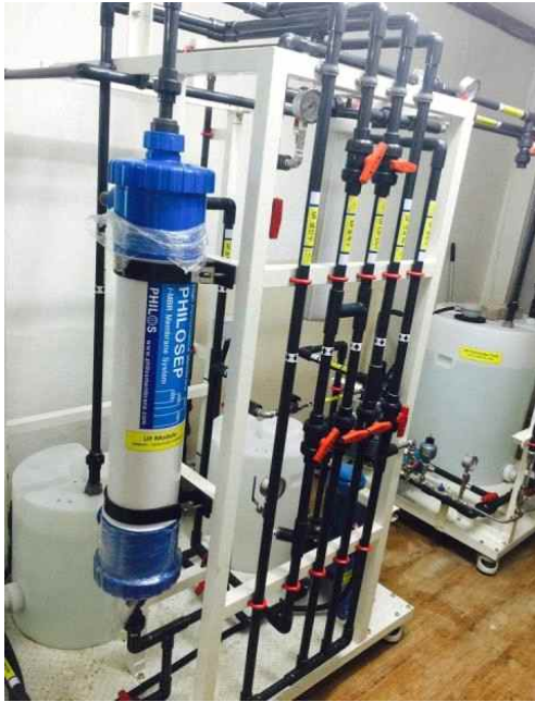
그림 2.7.105. 실험에 사용된 양분배합장치(좌) 및 양분농축회수장치(우)
