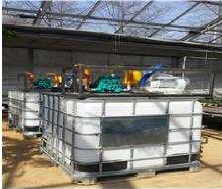
그림 2.4.30. 조류 배양기 pilot 사진
