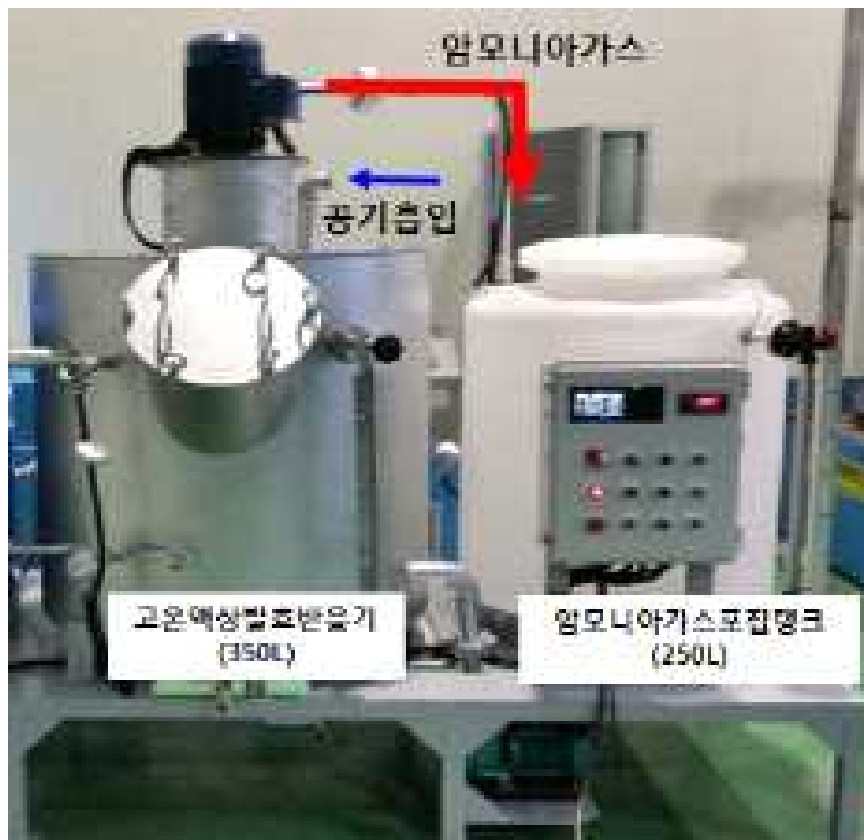
그림 2.7.103. 고온액상발효반응기 및 암모니아포집탱크
