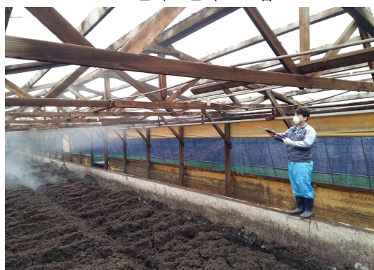
< 퇴비화 시설 발생 가스 측정>
