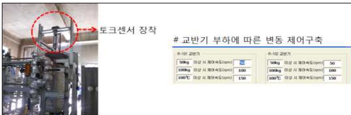
그림 2.7.83. 1톤/일급 수열탄화 반응기 교반강도(토크) 테스트(제어) 설비 구축
