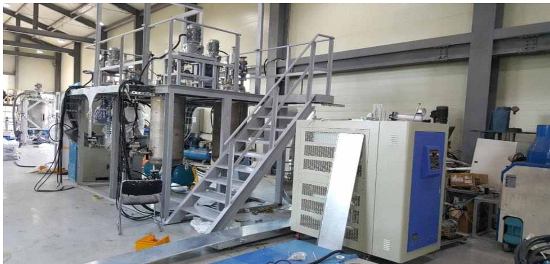
그림 2.7.59. Pilot plant급 수열탄화 통합공정 시스템제작 사진
