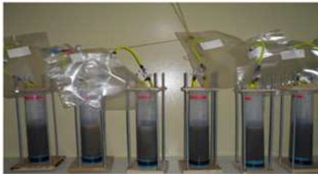
그림 2.1.36. Lab-scale 고상 혐기소화 실험장치
