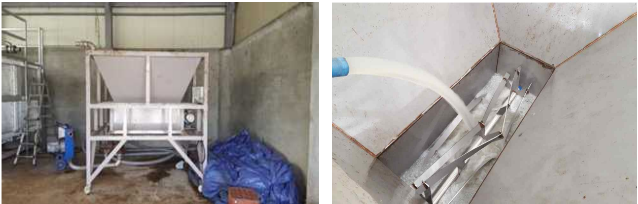
그림 2.1.43. 고상 가축분뇨 원료 분쇄/혼합 장치 사진
