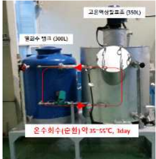
(고온액상발효반응기 내 온수순환파이프) (고온액상발효 및 열병합(온수회수) 장치) 그림 2.7.102 고온액상발효반응기 및 열병합(온수회수) 장치
