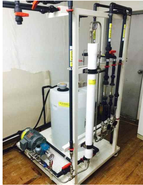
그림 2.7.105. 실험에 사용된 양분배합장치(좌) 및 양분농축회수장치(우)
