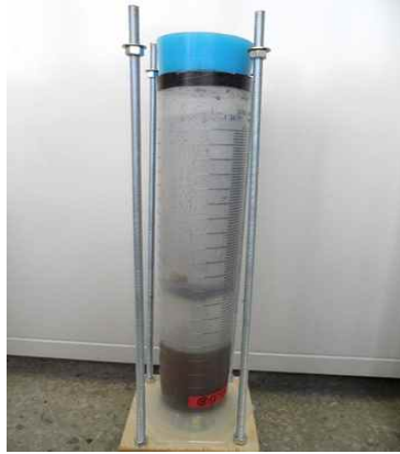
그림 2.1.32. Lab 규모 2L 고상혐기소화 장치
