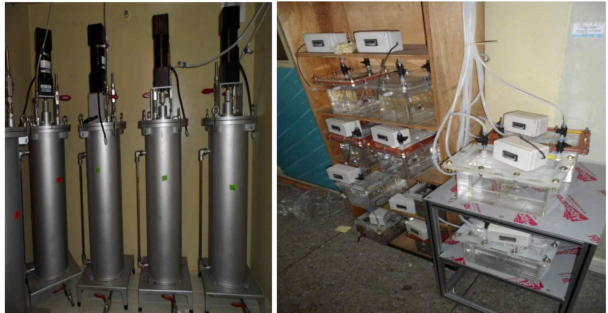
그림 2.1.21. 고상혐기소화 실험장치 설치 사진
