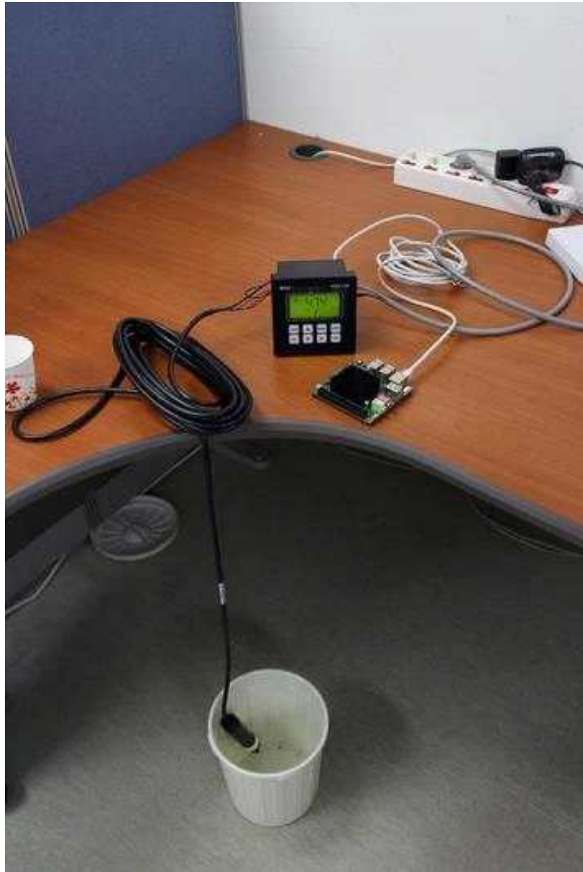
그림 2.6.10. pH 센서 테스트
