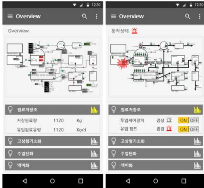
그림 2.6.20. 고상가축분뇨 에너지화 통합관리 모니터링 스마트폰 앱 오버뷰 화면 및 알람 동작 화면
