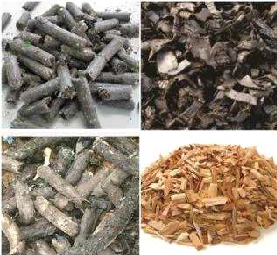
그림 2.6.55. 고형연료의 종류(왼쪽위부터 시계방향으로 RDF, TDF, WCF, RPF) (한국원자력문화재단, 2013)
