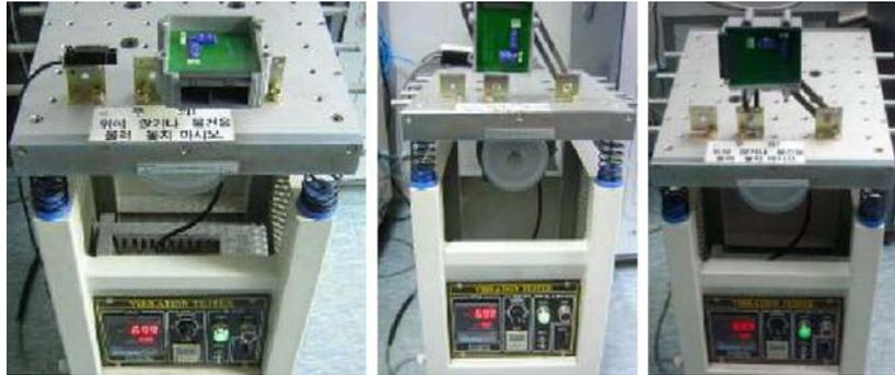
그림 1-85 내진성 시험(좌)전후, (중)상하, (우)좌우.
