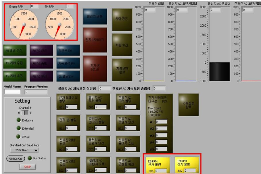
그림 3-43 자동 고장진단 방식에서 rpm 센서 모니터링 화면.
