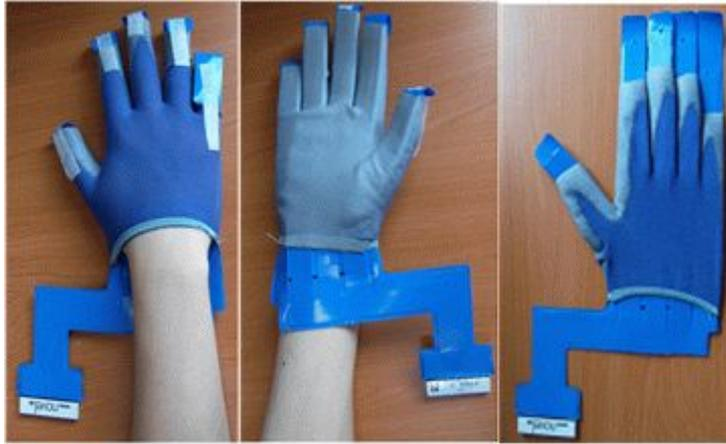
그림 2-50 실험에 사용한 손압력 센서 및 장착 모습.
