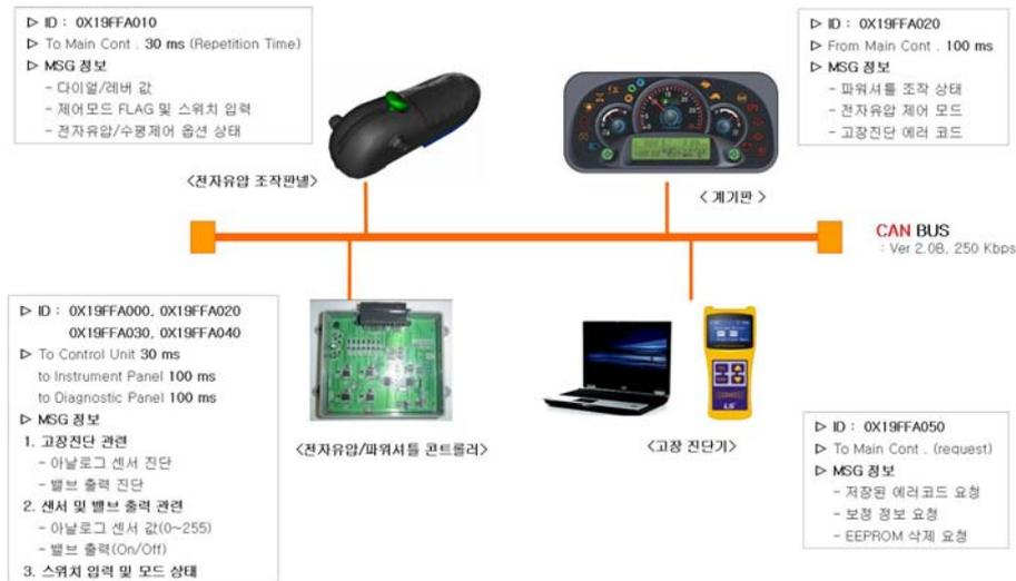
그림 3-51 고장 진단기의 통신시스템 구성.
