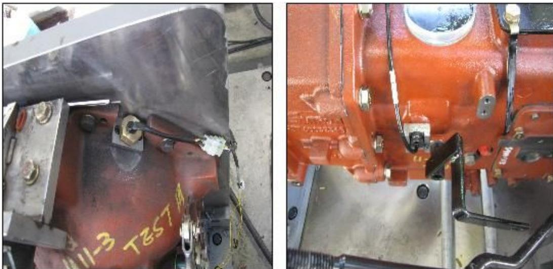
그림 1-29 엔진 회전수(왼쪽)와 변속기 회전수(오른쪽) 측정을 위해 설치된 홀 센서.
