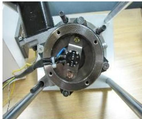
그림 1-33 액추에이터 변위 측정을 위한 포텐시오미터.
