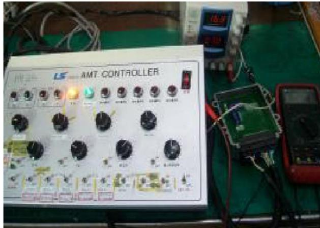
그림 1-89 통상전원전압 시험.
