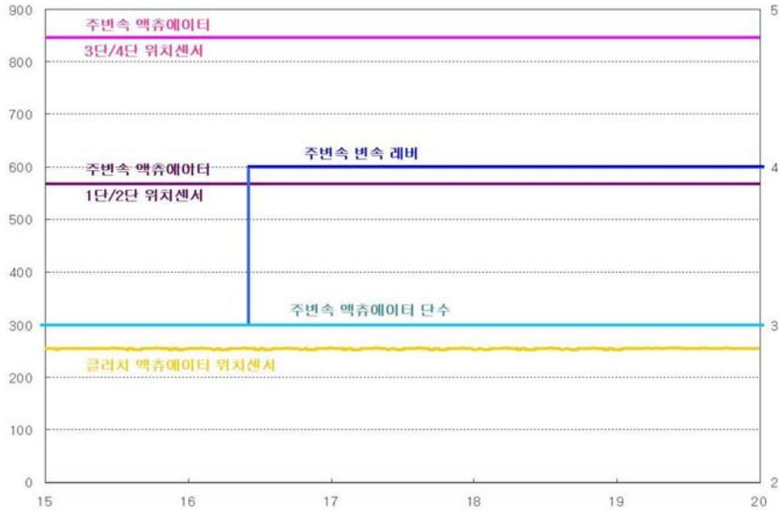
그림 3-49 클러치 액츄에이터 모터 커넥션 분리 상태.
