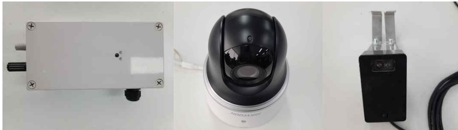
[그림] 모듈 이미지 (좌 : 온/습도 모듈, 환경 모듈 / 중앙 : CCTV / 우 : 사료빈 모듈)
