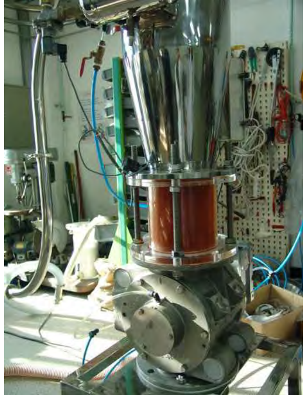
2차 원료 혼합 탱크 및 배출 로터리 밸브
