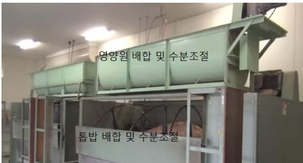
그림 1-7. 톱밥배지 혼합기(상부, 영양원 배합 및 수분조절; 하부, 톱밥 배합 및 수분조절).
