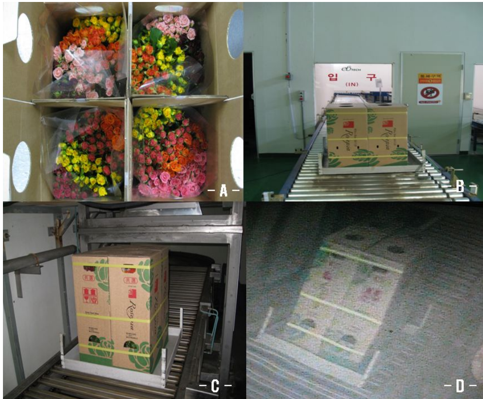
그림 3-3-24. 10MeV 전자빔을 이용한 조사선량 분포도 측정 및 모니터링 관리 (A: 전자빔 조사 시료, B: 10MeV 전자빔 조사 진입, C: 10MeV 인출창, D: 10MeV 전자빔 조사중)
