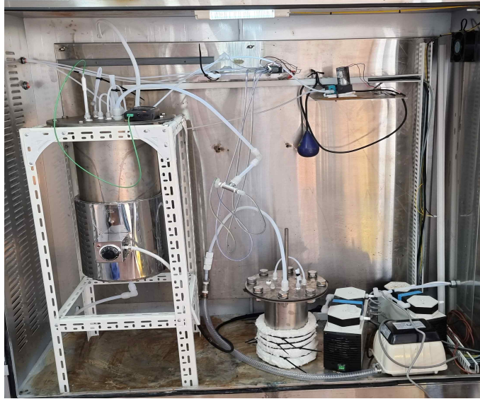
(라) 중형 이산화염소 발생기 개발 ( 기체상 이산화염소 25 g /min 발생 )
