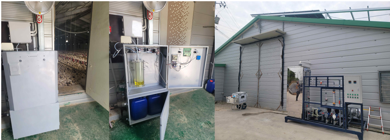
이산화염소 기체 생산부 + 이산화염소 기체 제조 컨트롤 및 서버 전송부
