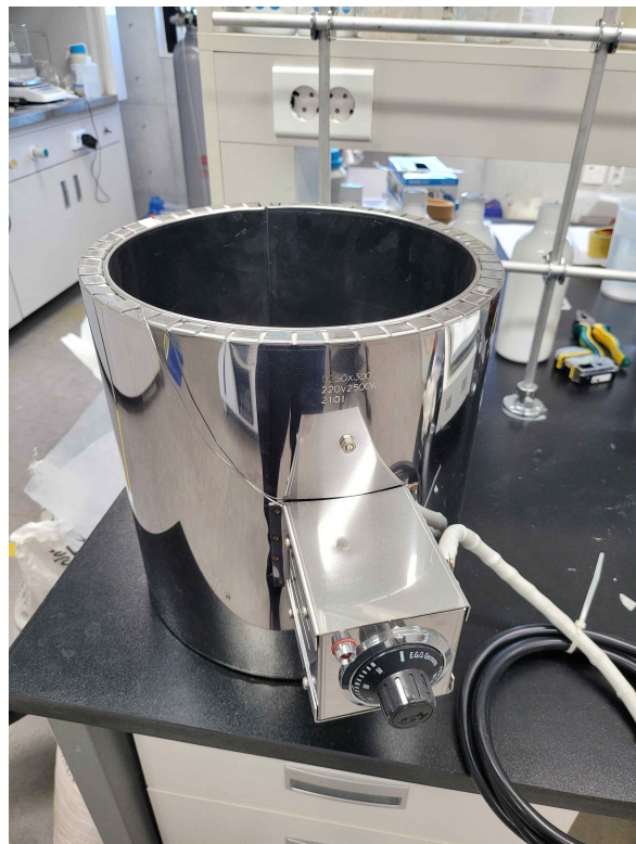
온도 조절용 heating jacket : 외경 290 mm × 내경 250 mm × 높이 350 mm
